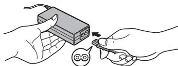
*Illustration 2-5 Connexion du cordon d'alimentation à l'adaptateur (prise à 3 broches)*
