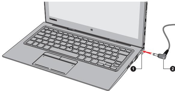
1. Prise Entrée adaptateur 19 V      2. Prise de sortie c.c. de l'adaptateur
