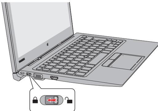
3. Alignez le câble de sécurité sur l'ouverture du loquet et fixez le câble.
