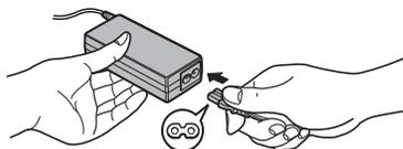
*Illustration 2-12 Connexion du cordon d'alimentation à l'adaptateur (prise à 3 broches)*
