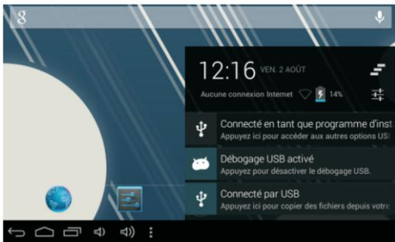
Appuyez sur "USB connecté", sélectionnez "Activer le stockage USB". L'appareil est reconnu par l'Explorateur de l'ordinateur. Vous pouvez désormais l'utiliser comme dispositif de stockage externe.
