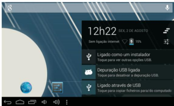
Prima o botão "USB ligado", seleccione "Activar armazenamento USB". O dispositivo é reconhecido no Explorador do computador. Agora pode utilizá-lo como dispositivo de armazenamento externo.
