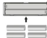
17. A substituição da bateria por um tipo incorreto comporta um risco de explosão. Retire as baterias usadas de acordo com as
