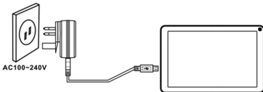
2. Cuando la batería esté totalmente cargada, retire el cargador del KIDS9QCBT, y luego de la toma de corriente.
