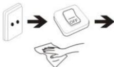
14. Débranchez l'appareil de la prise électrique et éteignez-le avant de le nettoyer.
