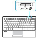
Placez sur **ON** le commutateur Marche/Arrêt d'alimentation et du pavé tactile situé sur le
