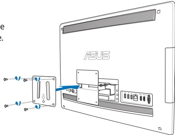
5. En suivant les instructions d'installation de votre kit de fixation murale (VESA100), sécurisez la plaquette de fixation métallique au mur à l'aide des quatre vis (M4 x 10L) fournies avec le kit. Prenez votre All-in-one PC en main et fixez-le au mur en faisant coulisser le support de fixation sur les rainures de la plaque métallique fixée au mur.
