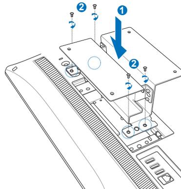
4. Sécurisez la plaquette au support de fixation avec les quatre vis (M3 x 8L) accompagnant votre kit de fixation murale et en respectant l'orientation de montage.
