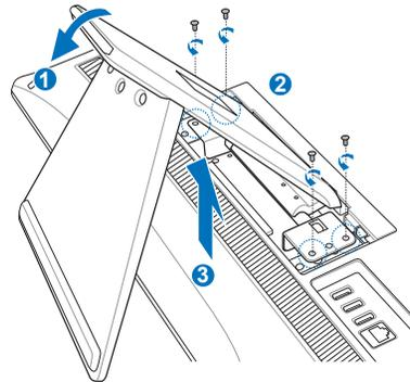
3. Alignez les pas de vis du support de fixation avec ceux situés à l'arrière du All-in-one PC et sécurisez l'ensemble à l'aide des quatre vis fournies (M4 x 7L).
