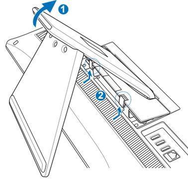
2. Abaissez le socle. Vous pouvez placer le All-in-one PC près du bord de la surface de travail pour vous assurer que le socle soit complètement abaissé. Retirez les quatre vis sécurisant le socle et conservez-les pour une utilisation future. Retirez le socle et mettez-le de côté.
