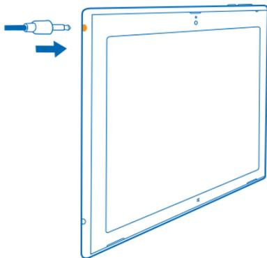
Ne connectez pas de produit créant un signal de sortie, car cela pourrait endommager l'appareil. Ne raccordez aucune source de tension au connecteur audio. Si vous connectez au connecteur audio un appareil externe ou un kit oreillette qui n'a pas été agréé pour cet appareil, faites particulièrement attention au niveau du volume.
