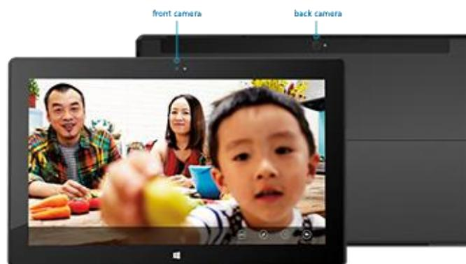
Utilisez l'une ou l'autre des caméras pour enregistrer des vidéos en haute définition avec une résolution 720p et un format 16:9 (écran large). Ces deux caméras permettent également de prendre des photos.
