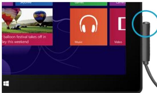
Un voyant lumineux apparaît à l'extrémité du connecteur pour indiquer que la tablette Surface est alimentée.
