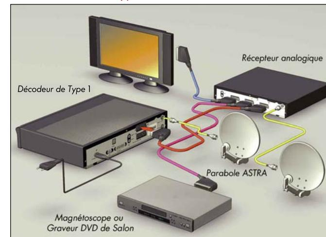
Schéma de raccordement pour l'installation avec un récepteur analogique.
