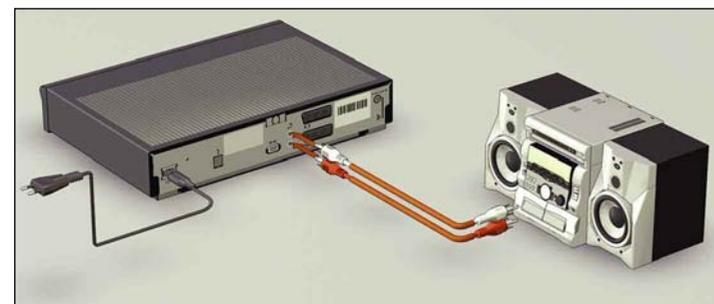
**L'astuce :** Grâce à ce branchement, vous pourrez écouter les radios avec le téléviseur éteint.
