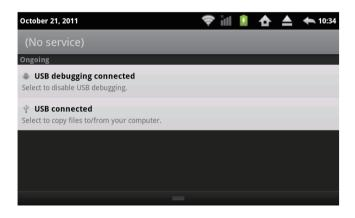
Appuyez sur «USB connected» (USB connecté), sélectionnez «Turn on USB storage» (activez le stockage USB). L'appareil est reconnu par Explorer de l'ordinateur. Il est dès lors utilisable comme stockage externe.
