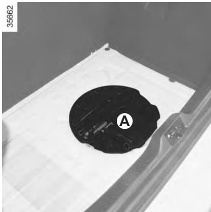
La présence des outils dans le bloc outils dépend du véhicule. Le bloc outils **A** est situé dans le bac sous le tapis de coffre. Soulevez le couvercle puis retirez-le.
