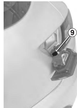
Tournez le porte-lampe 9 dans le sens inverse des aiguilles d'une montre et changez la lampe.
