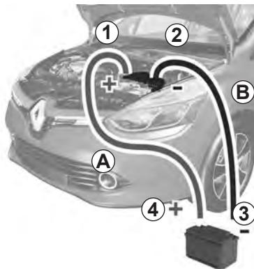
Fixez le câble positif **A** sur la borne **1** (+) puis sur la **borne 4** (+) de la batterie fournissant le courant.
