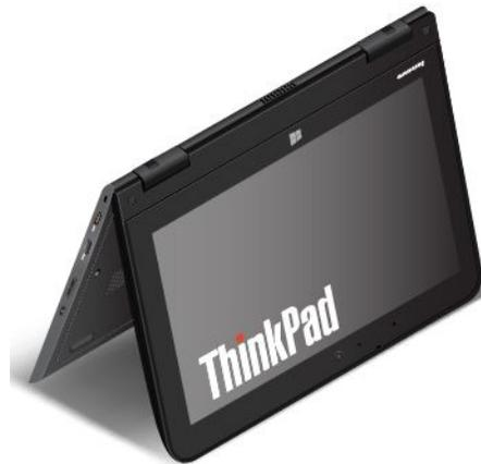
En mode tente, le clavier et le pavé tactile sont automatiquement désactivés. Vous pouvez néanmoins contrôler certaines fonctions de votre ordinateur via les boutons de la tablette et l'écran tactile multipoint, sans utiliser le clavier et le pavé tactile. Pour plus d'informations, voir « Utilisation des boutons de la tablette graphique » à la page 26 et « Utilisation de l'écran multitactile » à la page 27.
