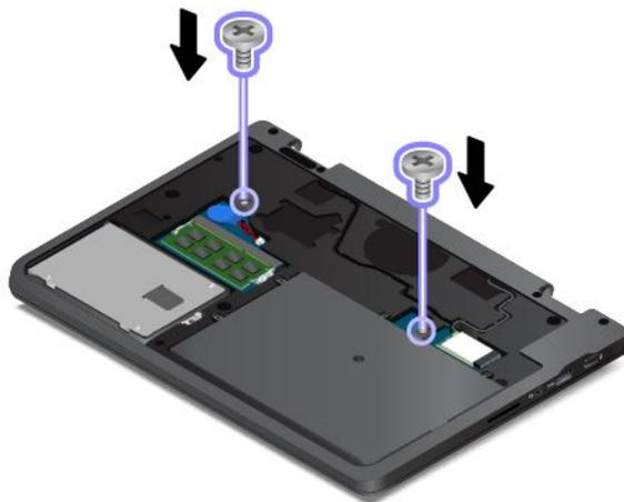
5. Installez le cache **1**, puis faites-le pivoter vers le bas **2**. Serrez les vis **3**.
