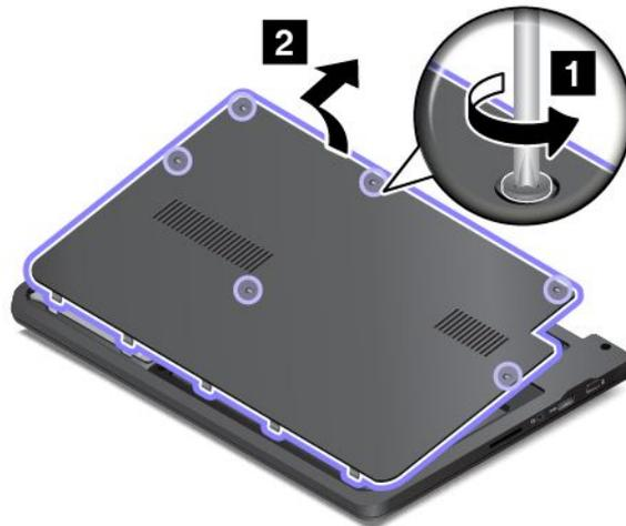
4. Retirez les vis de fixation du clavier.
