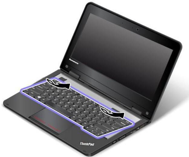
3. Faites glisser le clavier dans la direction indiquée par les flèches jusqu'à ce que les loquets du cadre du clavier soient cachés sous le panneau du clavier.
