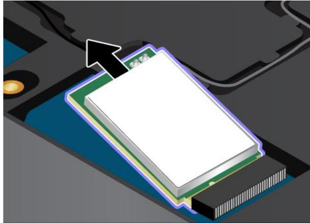
7. Alignez l'encoche de la nouvelle carte réseau local sans fil avec le repère situé dans l'emplacement. Insérez ensuite doucement la carte dans son emplacement selon un angle d'environ 20 degrés.
