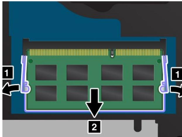
5. Repérez l'encoche sur le côté du bord de contact du module de mémoire que vous installez. Le côté avec encoche orientée vers le côté du bord de contact du connecteur, insérez le module de mémoire **1** dans le connecteur inférieur en l'inclinant d'environ 20 degrés, puis faites pivoter le module de mémoire vers le bas jusqu'à ce qu'il s'enclenche **2**.
