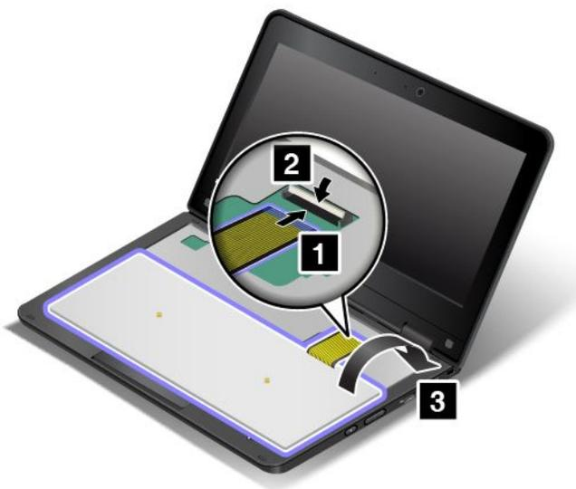
2. Insérez le clavier dans le panneau du clavier comme indiqué. Assurez-vous que les bords du clavier, à l'avant, se trouvent sous le cadre du panneau du clavier.
