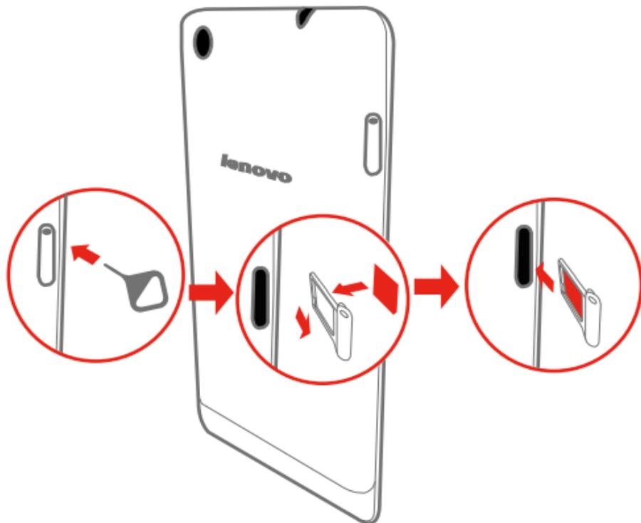
**Étape 1.** Insérez l'outil d'éjection SIM dans l'orifice du plateau de carte Micro SIM.
