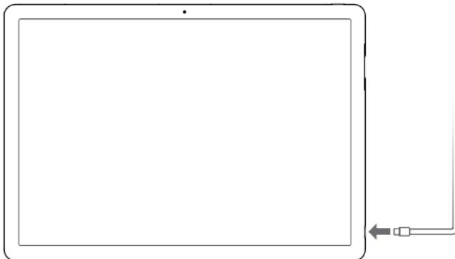
MateBook E viene preinstallato con una batteria irremovibile e ricaricabile. È possibile caricare MateBook E con l'adattatore e il cavo di carica USB C in dotazione. La batteria è completamente carica quando l'indicatore di carica è verde fisso.
