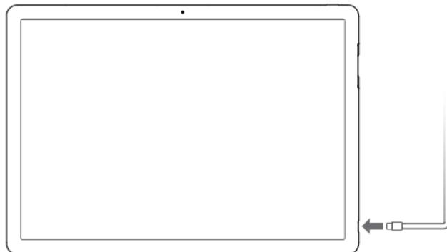
In uw MateBook E is een niet-verwijderbare, oplaadbare batterij geïnstalleerd. U kunt uw MateBook E opladen met de meegeleverde adapter en USB-C-oplaadkabel. De batterij is helemaal opgeladen wanneer de oplaadindicator groen blijft branden.
