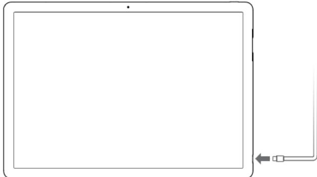
El MateBook E cuenta con una batería preinstalada que no se puede extraer y es recargable. Puede cargar el MateBook E con el adaptador y el cable USB-C de carga que se proporciona con él. La batería está totalmente cargada cuando el indicador de carga permanece verde sin parpadear.
