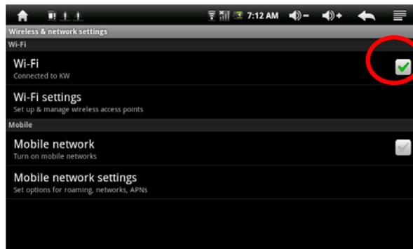
b. **Paramétrage du WIFI et connexion au réseau :** Sélectionnez « paramètres WIFI » pour entrer dans le wifi, le système détectera le nom du réseau sans fil automatiquement. Référez-vous à l'image ci-dessous, elle a détecté deux noms de réseaux WIFI :
