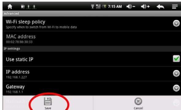
Revenez à l'étape de sélection du nom du réseau WIFI lorsque votre configuration manuelle est terminée et sauvegardée. Par exemple : Appuyez sur « KW »
