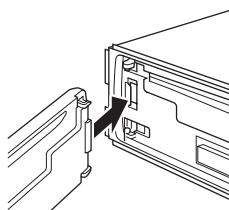
2 Druk vervolgens de rechterzijde vast tot het voorpaneel goed geplaatst is.
