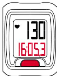
Remettez le chronomètre à zéro en maintenant la touche de fonctions enfoncée jusqu'à ce que "hold", "RESET", puis 0:00:00 apparaissent à l'écran.
