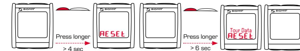
Reset Braking Distance / Bremsweg zurücksetzen / Réinitialiser distance de freinage
