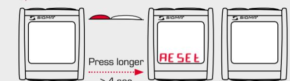
Reset Drag Race / Drag Race zurücksetzen / Remettre la fonction "Drag Race" à zéro
