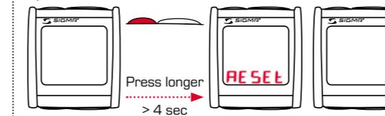
Reset Deceleration / Bremsverzögerung zurücksetzen / Remettre la température de freinage à zéro
