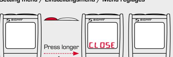
Reset Ride Time / Fahrzeit zurücksetzen / Remettre le temps à zéro
