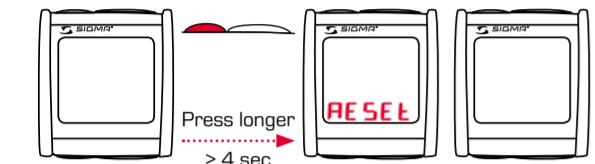
Reset Hwy Acceleration / Durchzugsmessung zurücksetzen / Remettre la mesure de la reprise à zéro
