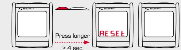
Reset Acceleration / Beschleunigung zurücksetzen / Remettre l'accélération à zéro
