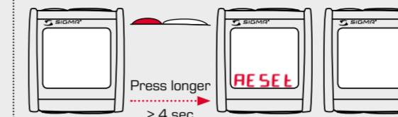
Reset Trip Distance / Fahrstrecke zurücksetzen / Remettre la distance à zéro
