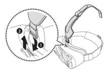
2 Faites coulisser l'autre extrémité du bandeau de fixation dans la fente prévue à cet effet sur la sangle principale.
