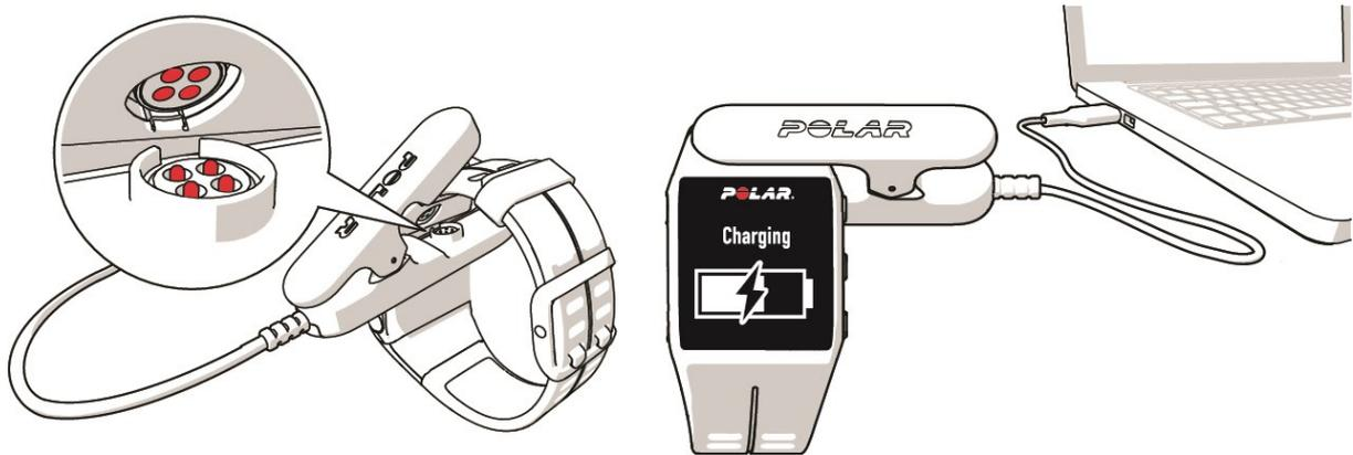
Assurez-vous que le connecteur USB s'enclenche bien, et que le logo Polar figurant sur le connecteur USB et le V800 sont orientés dans le même sens.
