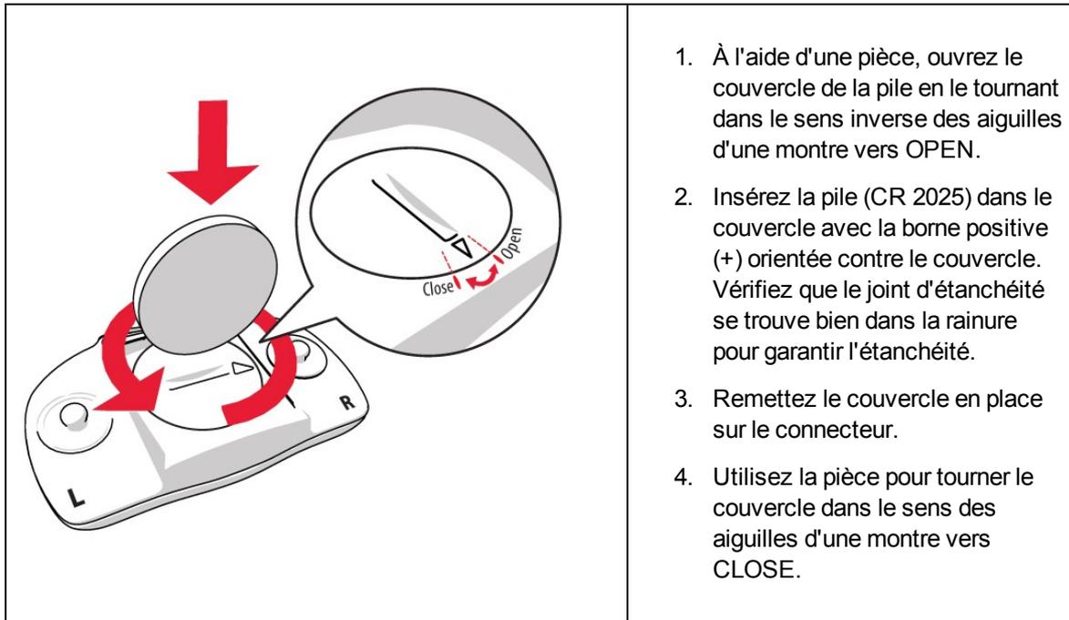
1. À l'aide d'une pièce, ouvrez le couvercle de la pile en le tournant dans le sens inverse des aiguilles d'une montre vers OPEN.
