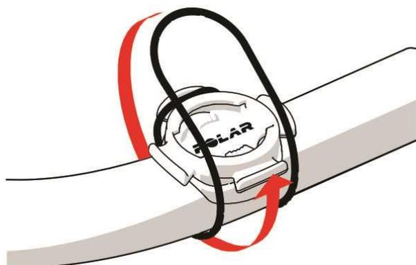
4. Alignez les rebords à l'arrière du V650 avec les fentes du support vélo, puis tournez dans le sens des aiguilles d'une montre jusqu'à ce que le V650 soit en place.
