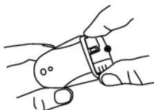
Veillez installer la pile (incluse dans l'emballage) avant d'utiliser l'accéléromètre\* pour la première fois.
