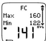
**La fréquence cardiaque** en battements par minute (bpm), qui alterne avec la fréquence cardiaque en pourcentage de fréquence cardiaque maximale (%).
