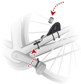
Une fois la position des capteurs réglée, serrez les attaches de câble de façon à ce que les capteurs restent en place.
