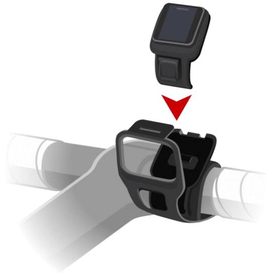
5. Refermez la lanière au-dessus de la montre, en la fixant en haut du support à l'aide de la fixation.
