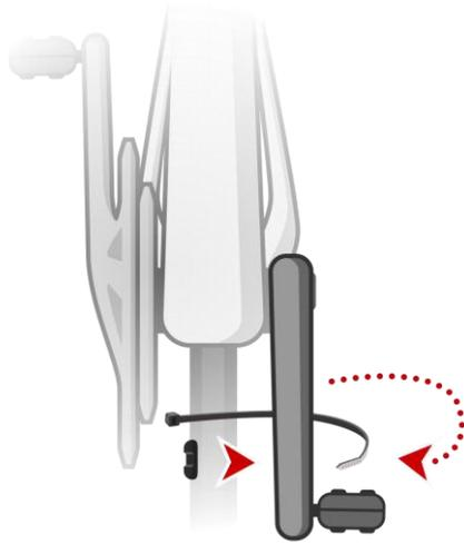
**Conseil :** assurez-vous que les différentes parties du capteur de cadence/vitesse sont correctement alignées sur votre vélo. L'aimant pour rayon de vélo doit passer devant la partie principale du capteur pour fourche de pédalier et l'aimant pour manivelle doit passer devant le haut du capteur.
