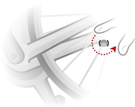
3. Ajustez la position de l'aimant pour rayon de vélo et du capteur de fourche de pédalier de façon à ce que lorsque la roue tourne, l'aimant passe devant le haut de la partie principale du capteur.
