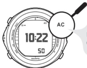
AC APPARAÎT EN HAUT À DROITE DE L'ÉCRAN LORSQUE L'ORDINATEUR DE PLONGÉE EST EN CONTACT AVEC L'EAU. CELA ACTIVE ÉGALEMENT LE MODE PLONGÉE.
