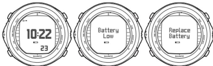
Si ce symbole apparaît en mode SURFACE ou si l'affichage est faible ou peu visible, c'est que la pile n'est plus assez puissante pour faire fonctionner l'ordinateur de plongée et il est nécessaire de la remplacer.
