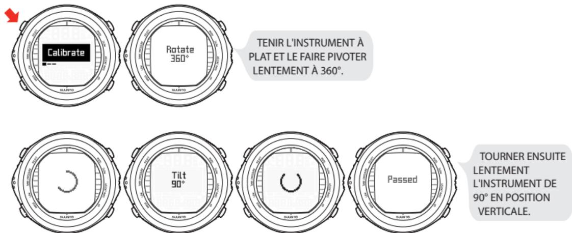
Si l'étalonnage échoue plusieurs fois de suite, il se peut que vous vous trouviez à proximité de sources magnétiques, telles que des objets métalliques volumineux, des lignes de tension ou des appareils électriques. Dans ce cas, changez d'endroit et réessayez d'étalonner votre boussole. Si l'étalonnage échoue toujours, contactez un centre d'entretien agréé par Suunto.
