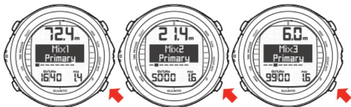
En mode MIXED (Mélange), l'ordinateur de plongée affiche également la profondeur maximale autorisée pour le mélange utilisé.
