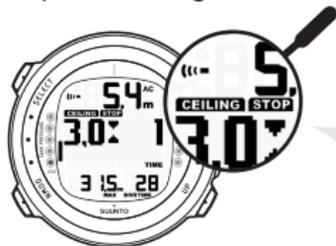
LORSQUE CEILING (PLAFOND) ET STOP (PALIER) SONT AFFICHES, EFFECTUER UN PALIER DE SECURITE OBLIGATOIRE D'UNE MINUTE A UNE PROFONDEUR DE 6 A 3 M.
