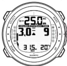
UNE FLÈCHE VERS LE HAUT, LE TEXT ASC TIME CLIGNOTANT ET L'ALERTE INDIQUENT QU'IL FAUT REMONTER. LE TEMPS DE REMONTÉE TOTAL MINIMUM COMPRENANT UN PALIER DE SÉCURITÉ EST DE 9 MINUTES. PLAFOND À 3 M.
