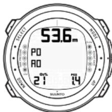
ACTIVATION DU MODE NITROX LA PROFONDEUR MAXIMALE AUTORISÉE D'APRÈS LES VALEURS O<sub>2</sub> % (21%) ET PO<sub>2</sub> (1,4 BAR) DÉFINIES EST DE 53,6 M.
