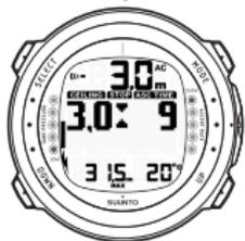
DEUX FLÈCHES POINTÉES L'UNE VERS L'AUTRE: VOUS ÊTES DANS UNE ZONE PLAFOND OPTIMALE À 3 M ET VOTRE TEMPS DE REMONTEE MINIMUM EST DE 9 MINUTES.
