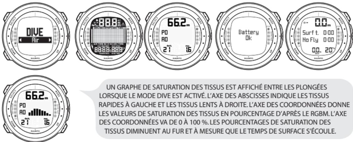
UN GRAPHE DE SATURATION DES TISSUS EST AFFICHÉ ENTRE LES PLONGÉES LORSQUE LE MODE DIVE EST ACTIVÉ. L'AXE DES ABCISSES INDIQUE LES TISSUS RAPIDES À GAUCHE ET LES TISSUS LENTS À DROITE. L'AXE DES COORDONNÉES DONNE LES VALEURS DE SATURATION DES TISSUS EN POURCENTAGE D'APRÈS LE RGBM. L'AXE DES COORDONNÉES VA DE 0 À 100 %. LES POURCENTAGES DE SATURATION DES TISSUS DIMINUENT AU FUR ET À MESURE QUE LE TEMPS DE SURFACE S'ÉCOULE.
