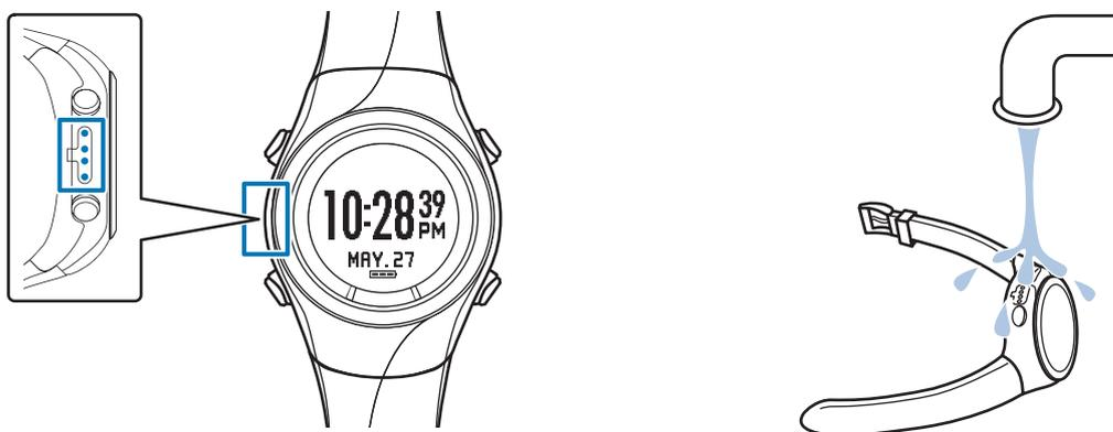
Si la charge ou la communication devient instable, nettoyez les points de contact de l'appareil et du socle de charge avec un coton-tige humide.
