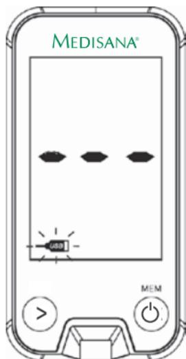
1. Verbinden Sie das Messgerät mit Hilfe des USB-Kabels mit Ihrem Computer. Das
