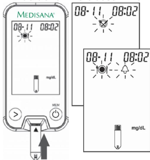
1. Führen Sie einen Teststreifen in Pfeilrichtung in das Gerät ein. Das ☀️-Symbol erscheint automatisch.
