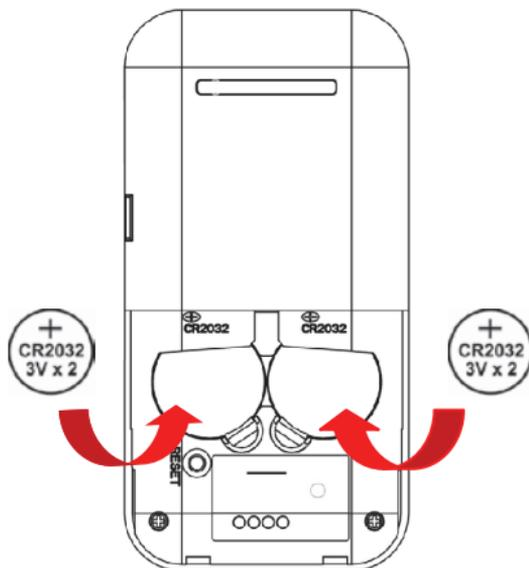
2. Setzen Sie zwei passende Batterien wie abgebildet ein. Das Gerät wird nach korrektem Einsetzen ein akustisches Signal geben.
