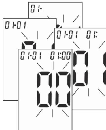
3. Wiederholen Sie Schritt 2, um Datum und Uhrzeit einzugeben. Es blinkt jeweils der Bereich, in dem gerade eine Einstellung vorgenommen wird.
