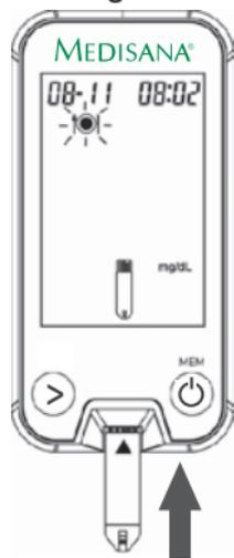
1. Führen Sie einen Teststreifen in Pfeilrichtung in das Gerät ein. Das
