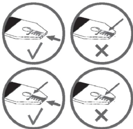
5. Geben Sie den Blutstropfen an den Blutaufnahme-Bereich am Ende des Teststreifens. **Achten Sie darauf, dass kein Blut auf die Oberseite des Teststreifens gelangt.** Damit ein korrektes Messergebnis ermittelt werden kann, muss genügend Blut in den Blutaufnahme-Bereich des Teststreifens aufgebracht werden, siehe Markierung oben.
