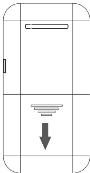
1. Öffnen Sie die Batteriefachabdeckung **2** auf der Rückseite durch Herunterziehen in Pfeilrichtung.
