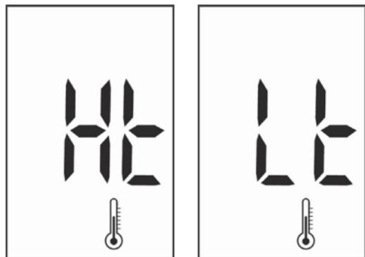
**“Ht” / “Lt” wird angezeigt. Umgebungstemperatur ist zu hoch bzw. zu niedrig, außerhalb der erforderlichen 10°C - 40°C (50°F - 104°F). Der Benutzer wird vor einem möglichen falschen Testergebnis gewarnt, falls der Test fortgesetzt wird.**
