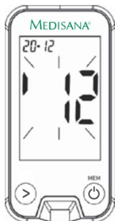
1. Nach dem Einlegen der Batterien schaltet sich das Gerät automatisch ein.
