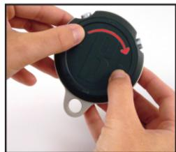
Tournez le couvercle du compartiment à piles dans le sens des aiguilles d'une montre pour ouvrir
