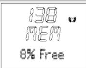
The image shows a digital display with '138' at the top, a small arrow icon to its right, 'MEM' in the middle, and '8% Free' at the bottom. | Pendant l'entraînement, le cardiofréquencemètre indique <b>MEM x% Free</b> toutes les 5 secondes lorsque moins de 10% de la mémoire sont disponibles.<br>Sur l'illustration : <b>MEM 8% Free</b> (encore 8% libres).               |
