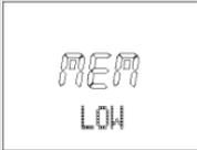
The image shows a digital display with 'MEM' at the top, three small bar graphs below it, and 'LOW' at the bottom.                          | Lors du passage au menu <b>Training</b> , le cardiofréquencemètre indique <b>MEM LOW</b> lorsque moins de 10% de la mémoire ou moins de 10 séances sont libres.                                                                    |
