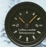
Indique l'angle d'inclinaison longitudinale de l'hélice
