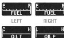
**Jauge du réservoir de l'aile gauche** Affiche la quantité de carburant contenue dans le réservoir de l'aile gauche.
