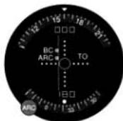
Les indicateurs de route, utilisés en combinaison avec les récepteurs NAV, servent à se régler sur la fréquence des stations VOR. Un indicateur de route, également connu sous le nom d'indicateur VOR, est un instrument monté sur le tableau de bord qui vous permet de déterminer sur quelle radiale VOR se trouve votre avion. Il vous aide également à voler sur une radiale en vous rapprochant ou vous éloignant d'une station VOR.
