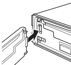
**2 Premere il lato destro del frontalino fino a quando è saldamente installato.**
