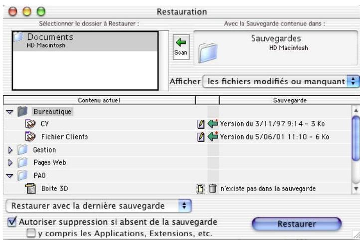
La fenêtre affiche le contenu du disque ou du dossier sélectionné dans la liste des éléments à restaurer (en haut à gauche), comparé au contenu de la sauvegarde.
