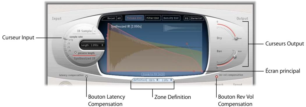
La partie supérieure (bombée) de Space Designer contient les paramètres globaux suivants :
