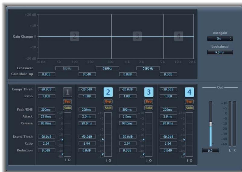
Les paramètres présents dans la fenêtre Multipressor sont répartis en trois catégories principales : la section de l'écran graphique située sur la partie supérieure, l'ensemble de contrôles de chaque bande de fréquence sur la partie inférieure, et les paramètres de sortie situés à droite.
