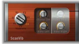
Les paramètres stéréo de la version mono de l'effet Scanner Vibrato sont masqués derrière un cache transparent à droite.
