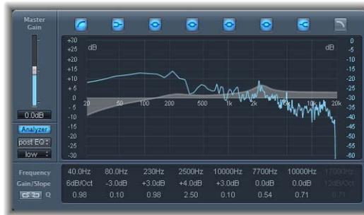
En apparence, le module de grande qualité Linear Phase EQ est très semblable au Channel EQ, puisqu'il partage avec lui les mêmes paramètres et la même disposition à huit bandes. Néanmoins, le Linear Phase EQ utilise une technologie sous-jacente différente, qui préserve intégralement la phase du signal audio (même lorsque vous appliquez les courbes d'égalisation les plus bizarres aux éléments transitoires les plus marqués).
