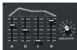
El control Velocity determina cuánto depende de la velocidad la intensidad de la envolvente. Cuando el control está en 0, se aplica el envolvente en su totalidad. Valores más altos reducen la intensidad para velocidades más bajas.
