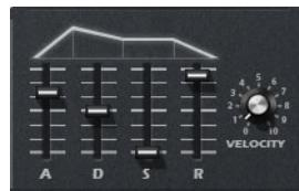
La commande Velocity détermine la relation entre la vitesse et l'intensité de l'enveloppe. Quand cette commande est configurée sur 0, l'enveloppe s'applique intégralement. Avec des valeurs plus élevées, plus la vitesse est faible, plus l'intensité de l'enveloppe baisse.
