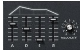
Das Velocity-Bedienelement bestimmt, inwieweit die Hüllkurvenintensität von der Anschlagstärke abhängt. Bei der Einstellung »0« wird die gesamte Hüllkurve angewendet. Höhere Werte verringern die Intensität bei geringeren Anschlagstärken.
