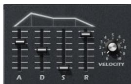
Il controllo Velocity determina il grado con cui l'intensità dell'inviluppo dipende dalla velocity. Quando il controllo è impostato su 0, l'inviluppo viene applicato completamente. Valori più elevati riducono l'intensità per le velocity più basse.
