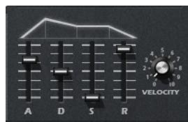
「VELOCITY」コントロールはペロシティーがエンベロープの強さに影響する程度を設定します。0に設定するとエンベロープが完全に適用されます。値が大きくなると、ペロシティーが弱いほどエンベロープの強さが低減されます。
