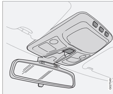
Un rappel lumineux et sonore incite les personnes (conducteur et passagers) qui n'ont pas bouclé leur ceinture de sécurité à le faire. Le rappel sonore dépend de la vitesse (à basse vitesse) et parfois du temps (au démarrage de la voiture). Le rappel lumineux est situé dans la console du plafond et dans le combiné d'instruments.
