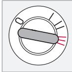
Le démarreur est actionné. Relâchez la télécommande dès que le moteur a démarré. La télécommande se replace automatiquement en position de conduite.
