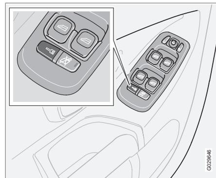
Le verrouillage automatique peut être activé et désactivé depuis le panneau de commandes de la porte conducteur. Cette fonction assure le verrouillage automatique des portes lorsque la vitesse de la voiture dépasse 7 km/h. Elles restent verrouillées jusqu'à ce qu'une porte soit ouverte de l'intérieur ou que toutes les portes soient déverrouillées depuis le panneau de commandes.
