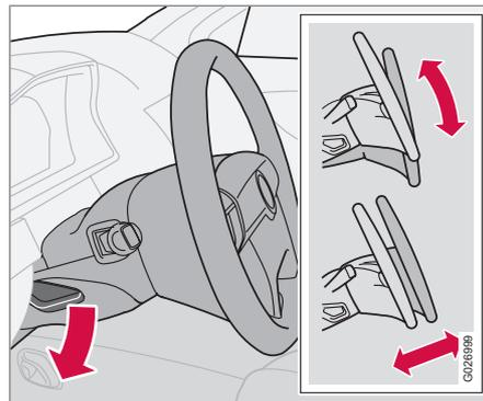
Le volant peut être réglé en hauteur et en profondeur. Poussez vers le bas la commande de réglage du volant située sur le côté gauche de la colonne de direction. Réglez ensuite le volant dans la position qui vous convient le mieux. Remettez en place la commande en
