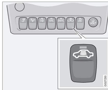
Pour éviter un déclenchement intempestif de l'alarme si on laisse un chien à l'intérieur, ou si on se trouve sur un bateau, il est possible de
