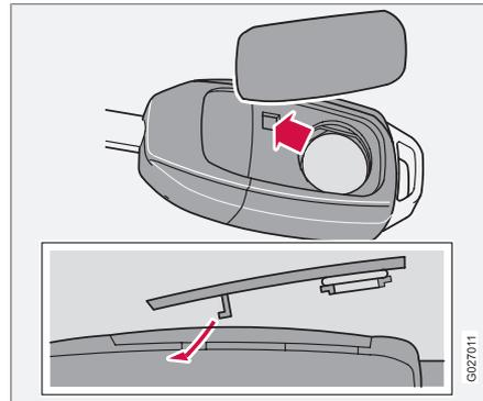
S'il arrive fréquemment que les serrures ne réagissent pas aux signaux de la télécommande à une distance normale, veillez à remplacer la pile.
