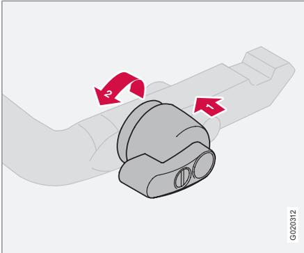
2. Enfoncez le bouton de verrouillage (1) et faites-le pivoter dans le sens inverse des aiguilles d'une montre (2) jusqu'à ce qu'un dé clic se fasse entendre.
