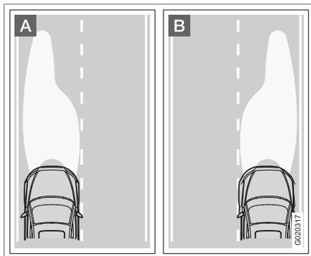
**A** Faisceau d'éclairage pour conduite à gauche.
