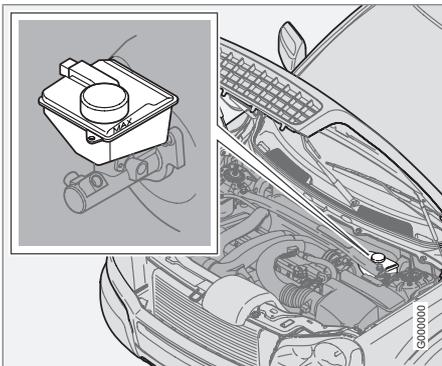
Les liquides de frein et d'embrayage ont le même réservoir<sup>1</sup>. Le niveau doit se trouver entre les repères **MIN** et **MAX** de la jauge. Vérifiez le niveau régulièrement. Remplacez le
