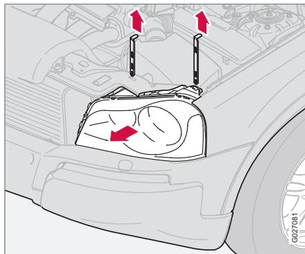
En cas de remplacement des feux de croisement, de route, de position/stationnement, le bloc de lampe entier doit d'abord être détaché. Pour remplacer l'une de ces ampoules, suivez les instructions suivantes puis les instructions relatives à chaque ampoule.
