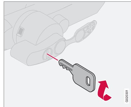
1. Insérez la clé et tournez-la dans le sens des aiguilles d'une montre en position déverrouillée.
