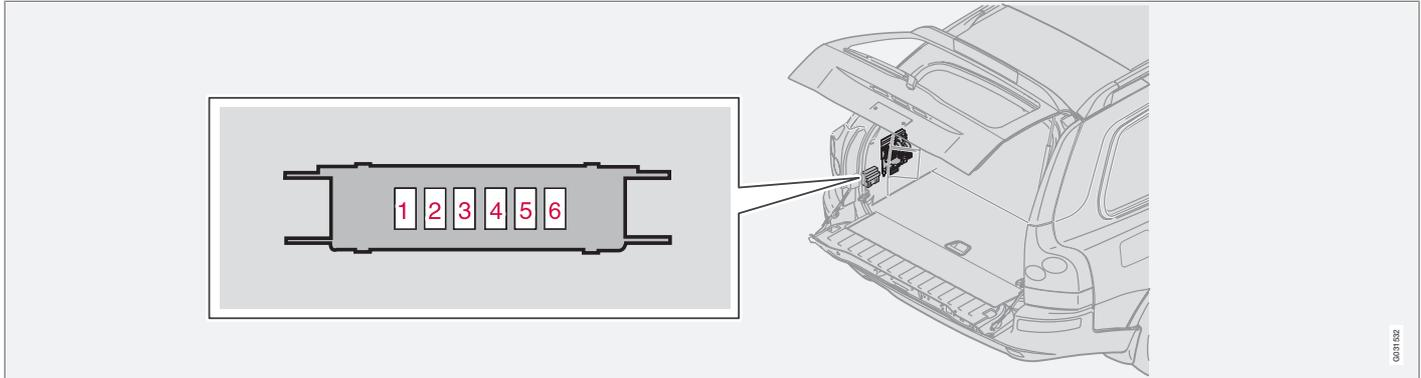
Le boîtier de fusibles est placé derrière le panneau du côté gauche.
