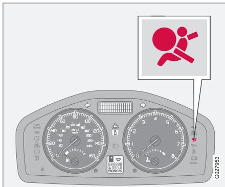
Le témoin d'avertissement s'allume dans le combiné d'instruments lorsque la télécommande est tournée en position de contact **I**, **II** ou **III**. Le témoin s'éteint après environ 6 secondes si le système de coussins gonflables est en état de marche.
