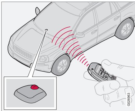
La télécommande verrouille/déverrouille toutes les portes latérales et le hayon en même temps. Les boutons de verrouillage et les poignées intérieures des portes latérales sont désactivés<sup>1</sup>.
