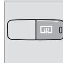
Ce bouton est utilisé pour dégivrer et désembuer rapidement la lunette arrière et les rétroviseurs extérieurs. Une pression sur l'interrupteur actionne cette fonction simultanément pour la vitre arrière et les rétroviseurs. Le témoin de l'interrupteur est allumé. Le dégivrage est automatiquement désactivé au bout de 12 minutes environ.
