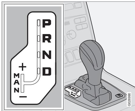
Pour passer de la position automatique **D** à une position manuelle, poussez le sélecteur de vitesses vers la position **M**. Pour passer de la position **M** à la position automatique **D**, poussez le sélecteur de vitesses vers la position **D**.
