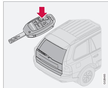
Si la voiture est équipée d'une alarme\*, le témoin indicateur sur le tableau de bord s'éteint pour indiquer que la voiture n'est plus complètement sous alarme. Les capteurs de mouvement et d'inclinaison de l'alarme ainsi que les capteurs d'ouverture du hayon sont désactivés.
