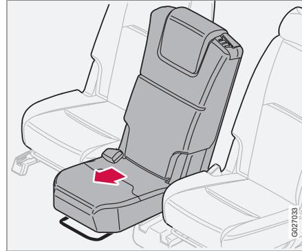
Le siège central du deuxième rang peut être avancé plus loin que les autres sièges. Le contact entre les passagers avant et un enfant placé sur le coussin rehausseur intégré peut ainsi être amélioré.
