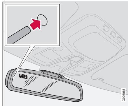
Un écran est intégré dans l'angle supérieur gauche du rétroviseur intérieur qui indique la direction de conduite (avant de la voiture). Huit directions différentes sont indiquées avec des abréviations en anglais : **N** (nord), **NE** (nord-est), **E** (est), **SE** (sud-est), **S** (sud), **SW** (sud-ouest), **W** (ouest) et **NW** (nord-ouest).
