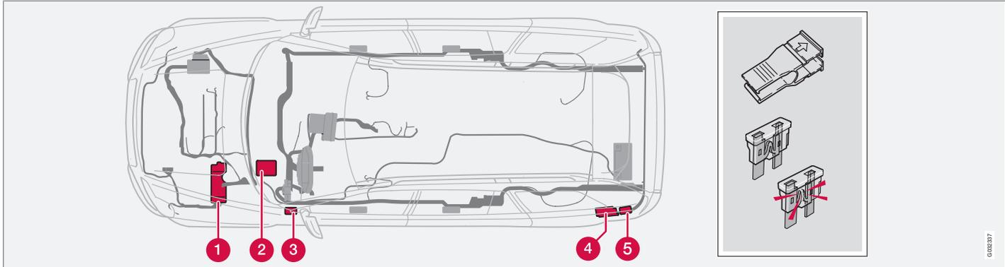
La placement des câbles peut être légèrement différent en fonction de la version du moteur. Les pièces indiquées dans la liste ont toutefois le même emplacement.
