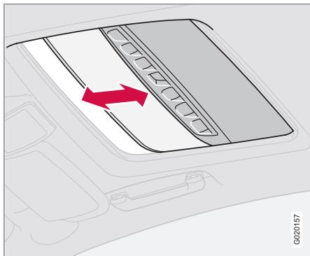
Le toit ouvrant est également doté d'un pare-soleil intérieur coulissant à commande manuelle. Lorsque vous ouvrez le toit ouvrant,
