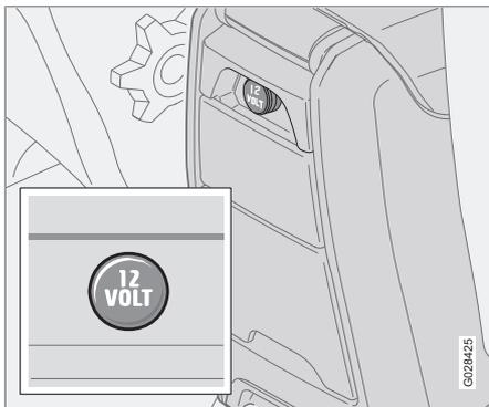
La prise électrique peut être utilisée pour différents accessoires comme un téléphone mobile ou une glacière. Elle est prévue pour une alimentation 12 V. Le courant maximal autorisé est de 10 A. La télécommande doit au moins être en position **I** pour que la prise fournisse du courant.
