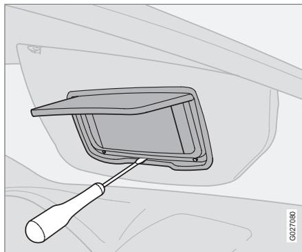
1. Enfoncez un tournevis droit sur le côté du clip central dans le bord inférieur du miroir. Soulevez afin que le clip central se détache.
