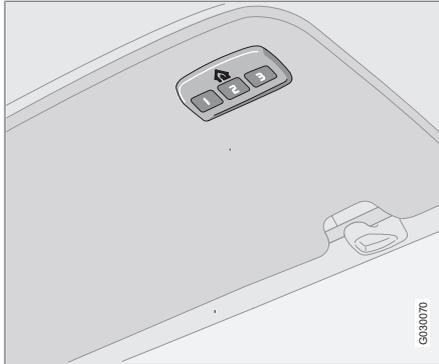
HomeLink® est une télécommande programmable qui permet de commander jusqu'à trois équipements (une porte de garage, un système d'alarme, un éclairage extérieur/intérieur par exemple) et ainsi de remplacer les télécommandes de ceux-ci. HomeLink® est livré intégré dans le pare-soleil gauche.
