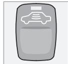
Utilisez ce bouton lorsque, pour une quelconque raison, vous désirez désactiver la fonction de serrure à pêne dormant (la serrure à pêne dormant implique que les portes ne peuvent pas être ouvertes de l'intérieur). Vous pouvez aussi utiliser ce bouton pour désactiver les détecteurs de mouvement et d'inclinaison de votre système d'alarme\*. La diode s'allume quand ces fonctions sont désactivées/déconnectées, reportez-vous aux pages 128 et 133.
