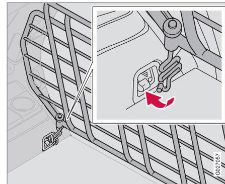
3. Placez la fixation de la grille de protection dans la position avant de la fixation.
