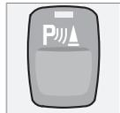
Le système est toujours actif lorsque la voiture est démarrée. Appuyez sur le bouton pour désactiver/réactiver le système d'alarme de recul. Voir aussi en page 155.
