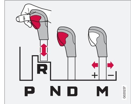
Il est toujours possible de déplacer librement le levier de vitesses d'avant en arrière entre **N** et **D**. Les autres positions sont bloquées par un loquet commandé à l'aide du bouton de blocage du sélecteur de vitesses.
