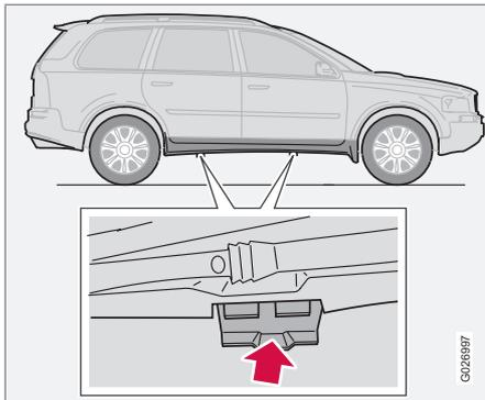
Si vous devez changer une roue dans un endroit fortement fréquenté, n'oubliez pas de placer votre triangle de signalisation. Il existe deux points de levage de chaque côté de la voiture. Les fixations sont centrées sous le bord inférieur des portières.
