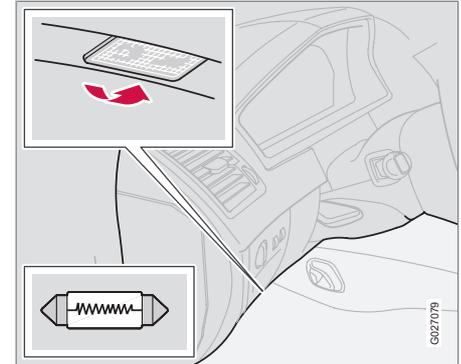
L'éclairage d'embranchement se trouve sous le tableau de bord des côtés conducteur et passager.
