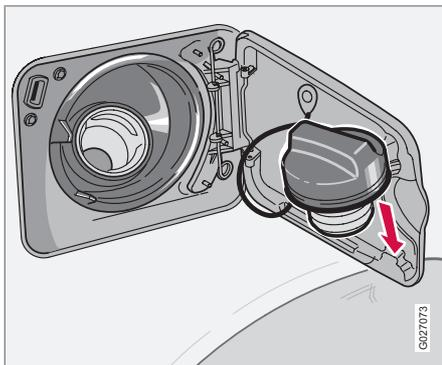
Le bouchon de réservoir se trouve à l'intérieur de la trappe sur l'aile arrière droite et peut être accroché à l'intérieur de la trappe.
