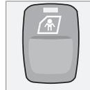
Active ou désactive le verrouillage de sécurité enfant électrique des portes arrière. La télécommande doit être en position **I** ou **II**. Une diode est allumée sur le bouton lorsque le verrouillage de sécurité enfant est activé. Un message apparaît à l'écran lorsque vous activez ou désactivez le verrouillage de sécurité enfant, voir page 130.
