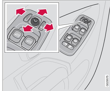
Les commandes pour régler les deux rétroviseurs extérieurs sont placées le plus en avant sur l'accoudoir de la porte du conducteur. Les rétroviseurs peuvent être manœuvrés avec le contact en positions **I** et **II**.
