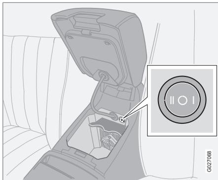
L'accoudoir rabattable des sièges avant contient un réfrigérateur. Ajustez le niveau de refroidissement avec le bouton (voir illustration). Le réfrigérateur fonctionne lorsque le moteur tourne ou en position de contact **II**.
