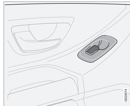
Les vitres des portes arrière peuvent se manœuvrer avec les commandes de chaque porte correspondante ou avec les commandes sur la porte du conducteur. Si le témoin de l'interrupteur de neutralisation des vitres électriques des portes arrière (situé sur le panneau de commandes de la porte conducteur) est allumé, les vitres arrière ne peuvent être commandées qu'à partir de la porte conducteur.
