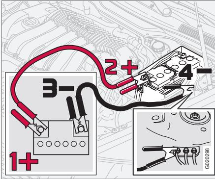
Si la batterie de la voiture est déchargée, il est possible de se servir d'une batterie auxiliaire ou de celle d'un autre véhicule. Veillez toujours à ce que les pinces du câble de démarrage soient bien serrées pour éviter la production d'étincelles lors d'une tentative de démarrage.
