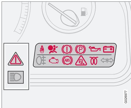
Tous les témoins de contrôle et d'avertissement<sup>1</sup> s'allument lorsque la télécommande est placée en position II avant le démarrage. Le fonctionnement des témoins est alors vérifié. Une fois le moteur démarré, tous les témoins doivent s'éteindre, à l'exception du témoin de frein de stationnement qui ne s'éteint que lorsque le frein est desserré.
