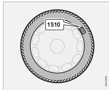
Les pneus ont une durée de vie limitée. Au bout de quelques années, ils commencent à durcir et leur capacité d'adhérence diminue. Dans la mesure du possible faites monter des pneus de remplacement neufs ayant été stockés le moins longtemps possible. Ceci est particulièrement important pour les pneus d'hiver. Les
