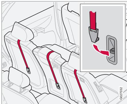
La voiture est équipée de points de fixations supérieure pour sièges enfant. Ces points de fixation sont placés au dos des sièges arrière.
