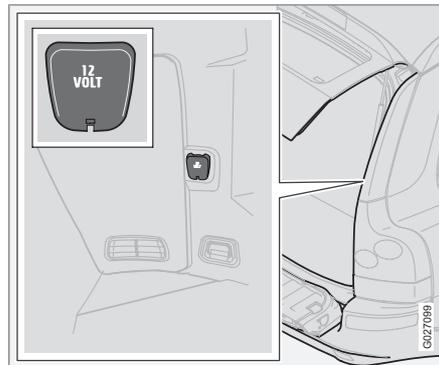
Ouvrez le cache pour utiliser la prise électrique. La prise fonctionne que le contact soit mis ou non.
