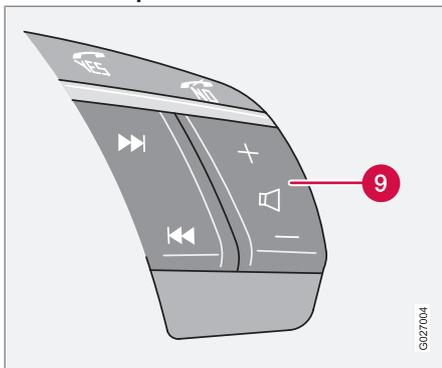
Les quatre touches situées au bas de la commande au volant sont communes à la radio et au téléphone. La fonction du bouton dépend du système activé. La commande au volant permet de régler le volume sonore, de passer d'une fréquence présélectionnée à l'autre ou de changer de page CD. Les deux boutons supérieurs sur le clavier (**Yes** et **No**) servent à répondre respectivement terminer un appel.
