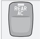
Appuyez sur l'interrupteur pour activer l'air conditionné dans la partie arrière de l'habitacle. Cette fonction est désactivée dès que l'on coupe le contact.
