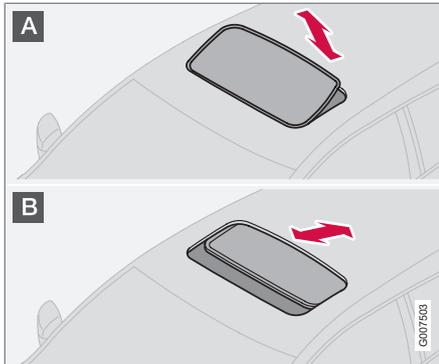
La commande du toit ouvrant est située dans le plafond. Le toit peut être ouvert en deux positions :
