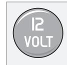
La prise électrique peut être utilisée pour alimenter divers accessoires 12 volts, par ex. un téléphone mobile ou une glacière.
