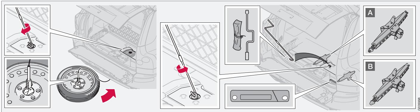
La roue de secours est placée sous la voiture. Le cric\*, la trousse à outils\* et la manivelle se trouvent sous la planche du compartiment à bagages. La manivelle est composée de deux éléments. L'un est placé dans la trousse à outils et l'autre sous celle-ci.
