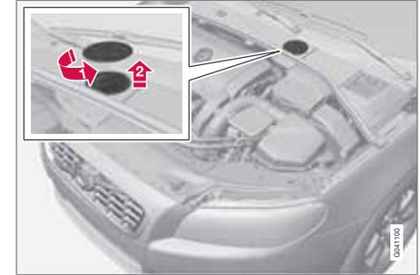
Le réservoir de liquide est placé du côté conducteur.
