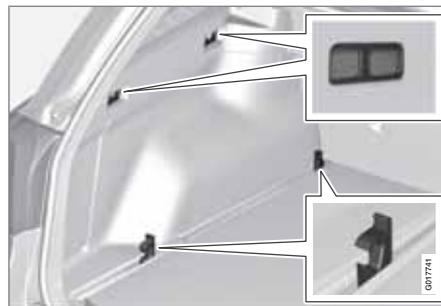
Des chaque côté du compartiment à bagages se trouvent plusieurs points de fixation prévus pour l'arrimage de la charge. Ils sont placés au sol et sur les bords supérieurs des côtés du compartiment à bagages.
