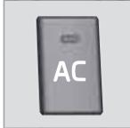
Lorsque le témoin du bouton **AC** est allumé, la climatisation est commandée automatiquement par le système. Dans ce cas, l'air entrant est refroidi et déshumidifié.
