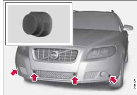
*Emplacement des capteurs avant.*
