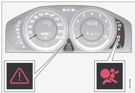
Le témoin d'avertissement s'allume dans le combiné d'instruments lorsque la télécommande est en position de contact II. Le témoin s'éteint après environ 6 secondes si le système de coussins gonflables ne présente pas de panne.
