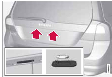
1. Desserrez les vis avec un tournevis.
