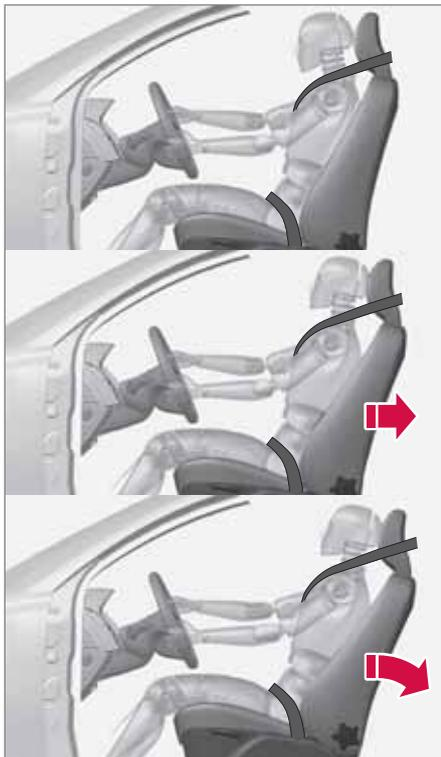
Le système WHIPS (Whiplash Protection System) est constitué de dossiers absorbeurs d'énergie et d'appuie-tête spécifiques intégrés dans les deux sièges avant. Le système est activé en cas de collision par l'arrière en prenant en compte l'angle de la collision, la vitesse et les caractéristiques de l'autre véhicule.
