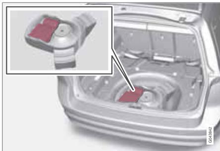
Le kit de réparation provisoire de crevaison (TMK; Temporary Mobility Kit) permet de réparer une crevaison ou de contrôler et ajuster la pression de pneu. Il se compose d'un compresseur et d'un réservoir avec du liquide d'étanchéité. Le kit sert pour une réparation provisoire. Le flacon de liquide d'étanchéité doit être remplacé avant la date de péremption et après utilisation.
