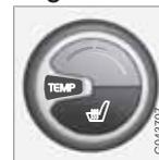
La molette permet de régler la température. Avec l'ECC\*, la température peut être réglée séparément du côté conducteur et du côté passager.
