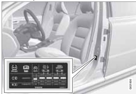
L'autocollant de pressions de pneu sur l'intérieur du montant de porte du côté conducteur (entre les portes avant et arrière) quelle pression les pneus doivent avoir à différentes conditions de charge et de vitesse. La pression correcte est aussi indiquée dans le tableau de pressions de pneu, voir page 417.
