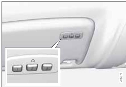
HomeLink®<sup>1</sup> est une télécommande programmable qui permet de commander à distance jusqu'à trois équipements (par exemple un système d'ouverture de porte de garage, un système d'alarme, un éclairage extérieur/intérieur, etc.) et ainsi de remplacer les télécommandes de ceux-ci. Pour plus d'informations sur HomeLink®, visitez : [www.homelink.com](http://www.homelink.com) ou téléphonez au 00 8000 466 354 65 (ou le numéro surtaxé +49 6838 907 277).
