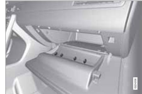
Le manuel de conduite et d'entretien et les cartes routières par exemple peuvent être rangés à cet endroit. Il y a un porte-stylo sur la face intérieure de la porte de la boîte à gants. La boîte à gants peut être verrouillée à l'aide de la lame de clé, consultez les pages 52 et 62.
