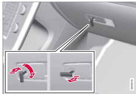
La boîte à gants ne peut être verrouillée/déverrouillée qu'à l'aide de la lame de clé de la télécommande. Pour de plus amples informations sur la lame de clé, voir page 52.
