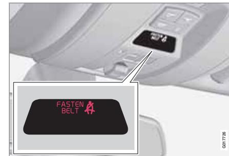
Un rappel lumineux et sonore incite les personnes qui n'ont pas bouclé leur ceinture de sécurité à le faire. Le rappel sonore dépend de la vitesse et parfois du temps. Le rappel lumineux est situé dans la console du plafond et dans le combiné d'instruments.
