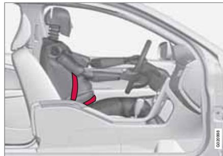
La ceinture de sécurité doit toujours être utilisée pendant la grossesse. Mais il est important de l'utiliser correctement. La ceinture de sécurité doit se coller contre l'épaule et la partie diagonale doit se placer entre les seins et sur le côté du ventre.
