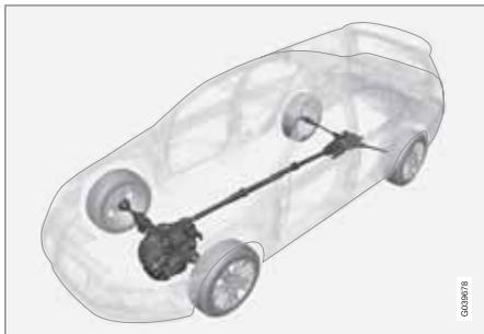
La transmission intégrale signifie que la voiture est entraînée simultanément par les quatre roues.
