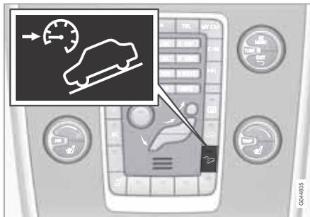
HDC est activé et désactivé avec un interrupteur situé sur la console centrale. Une diode sur le bouton s'allume lorsque la fonction est activée. Lorsque HDC est en action, le témoin
