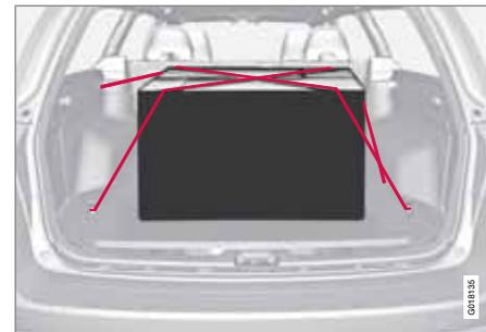
Charge arrimée aux points de fixation supérieurs et inférieurs.
