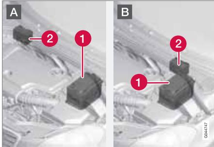
A : voiture à conduite à gauche. B : voiture à conduite à droite. 1. Batterie de démarrage<sup>3</sup>. Batterie d'appoint.
