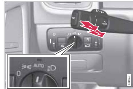
Commutateur d'éclairage et levier au volant.
