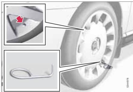
5. Vissez l'œillet de remorquage avec la clé à écrou de roue\* jusqu'en butée comme sur l'illustration ci-dessous.
