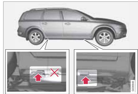
Si un cric d'atelier est utilisé pour soulever la voiture, il doit être placé sur le bord avant du cadre de moteur.
