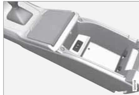
L'entrée AV/AUX se trouve sous l'accoudoir de la console de tunnel.
