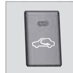
Lorsque la recirculation est activée, le témoin orange du bouton s'allume. Cette fonction est sélectionnée pour isoler l'habitacle de l'air vicié extérieur, des gaz d'échappements etc. L'air est ainsi recirculé et remis en circulation, c'est-à-dire qu'aucun air provenant de l'extérieur de la voiture n'entre dans l'habitacle lorsque la fonction est activée.
