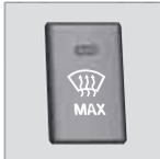
Cette fonction permet de dégivrer et de débarrasser rapidement le pare-brise et les vitres latérales. L'air arrive sur les vitres. Le témoin du bouton de dégivrage s'allume lorsque la fonction est active.
