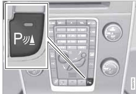
Le système est automatiquement activé au démarrage du moteur. Le témoin du commutateur est allumé. Si l'aide au stationnement est désactivée avec le bouton, la diode s'éteint.
