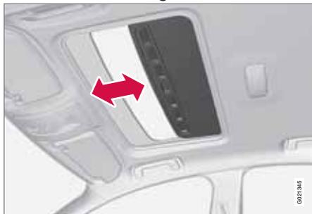
Une pression longue sur le bouton de verrouillage permet de fermer le toit ouvrant et toutes les vitres, reportez-vous aux pages 49 et 61. Les portes et le hayon sont verrouillés. Si vous devez interrompre la fermeture, appuyez à nouveau sur le bouton de verrouillage.
