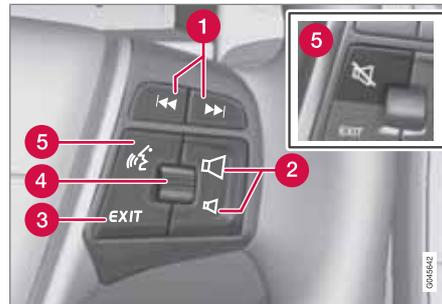
**1** Une **courte pression** permet de passer d'une plage à une autre sur un CD ou d'une station de radio mémorisée à l'autre<sup>4</sup>. Une **pression longue** permet d'avancer rapi-
