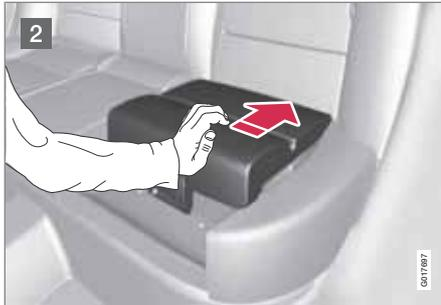
**2** Poussez le coussin rehausseur vers l'arrière pour le verrouiller.
