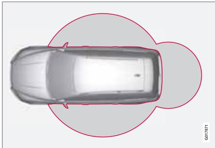
La fonction Keyless drive du VPC permet de déverrouiller, conduire et verrouiller la voiture sans clé. Il suffit d'avoir le VPC avec soi. Le système rend l'ouverture de la voiture plus facile, par exemple lorsque vous avez les mains occupées.
