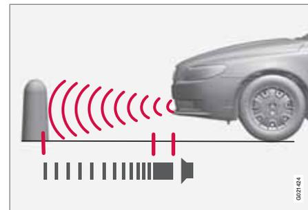
La zone de détection devant la voiture est d'environ 0,8 m. Le signal sonore indiquant un obstacle à l'avant provient de l'un des haut-parleurs avant.
