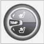
Les sièges avant ventilés ne peuvent être sélectionnés que si l'ECC est installé dans la voiture. Le système de ventilation est composé de ventilateurs dans les sièges et les dossiers qui aspire l'air à travers la garniture des sièges. L'effet de refroidissement augmente en proportion de la fraîcheur de l'air de l'habitacle.
