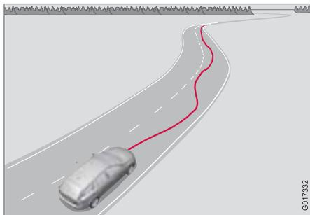
La fonction DAC (Driver Alert Control) est prévue pour attirer l'attention du conducteur lorsqu'il commence à perdre sa concentration sur la conduite et à zigzaguer, lorsqu'il est distrait ou qu'il s'endort par exemple.
