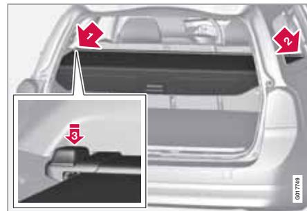
Tirez le cache-bagages et fixez-le dans les encoches sur les montants arrière du compartiment à bagages.
