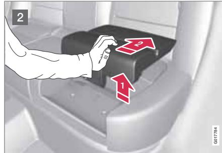
**2** Levez le bord avant du coussin rehausseur et poussez-le vers l'arrière contre le dossier pour le verrouiller.
