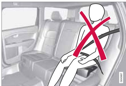
Emplacement incorrect, la tête ne doit pas être placée au-dessus de l'appuie-tête et la ceinture ne doit pas passer en dessous du niveau de l'épaule.
