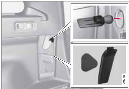
L'ampoule de clignotant de combiné arrière doit être remplacée à partir du compartiment à bagages.
