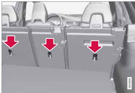
La voiture est équipée de points de fixation supérieurs pour certains modèles de sièges enfant face à la route. Ces points de fixation sont placés à l'arrière du siège.
