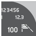
Le nombre de traits correspondant à la distance temporelle apparaît lors du réglage et pendant quelques secondes puis une version réduite du symbole apparaît à droite de l'écran. Le même symbole apparaît aussi lorsque le régulateur adaptatif de vitesse et de distance ACC est activé.
