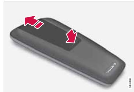
1. Pressez la patte de verrouillage du couvercle de piles et poussez le couvercle vers la lentille IR.
