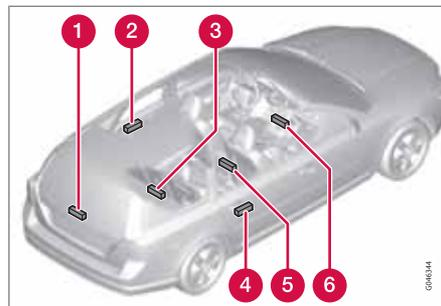
Le système Keyless possède plusieurs antennes intégrées à différents endroits sur la voiture :
