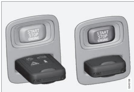
Contacteur d'allumage avec télécommande retirée/insérée et bouton **START/STOP ENGINE**.
