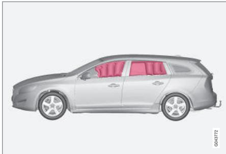
Le rideau gonflable IC (Inflatable Curtain) est un composant du système SIPS (p. 38) et du système de coussins gonflables (p. 34). Il est monté le long des deux côtés du plafond et aide à protéger le conducteur et les passagers assis sur les sièges extérieurs de la voiture. Lors d'une forte collision, les capteurs réagissent et le rideau gonflable se gonfle.
