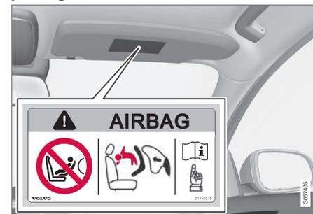
Autocollant sur le pare-soleil du côté passager.
