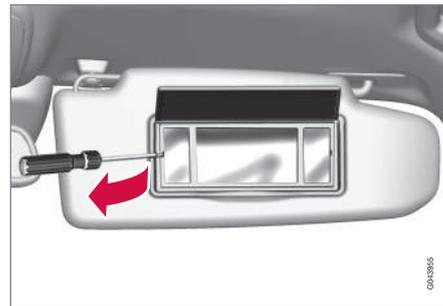
1. Insérez un tournevis sous la lentille et faites levier avec précaution sur la patte, sur le bord.
