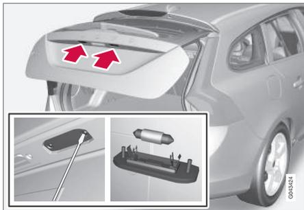
1. Desserrez les vis avec un tournevis.
