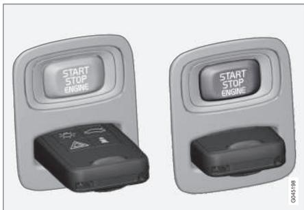
Contacteur d'allumage avec télécommande retirée/insérée.
