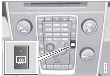
Ce bouton est utilisé pour dégivrer et désembuer rapidement la lunette arrière et les rétroviseurs extérieurs.
