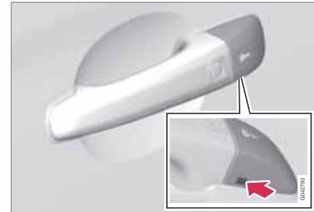
Si le verrouillage centralisé ne peut pas être activé avec le VPC, si les piles sont déchargées par exemple, il est possible de déverrouiller la porte avant gauche avec la lame de clé du VPC (voir page 52).
