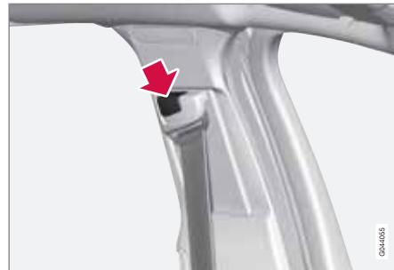
Régler en hauteur de la boucle coulissante de la ceinture de sécurité. Appuyez sur le bouton et déplacez la boucle coulissante en hauteur. Placez la boucle coulissante aussi haut que possible sans que la ceinture ne frotte sur la gorge.
