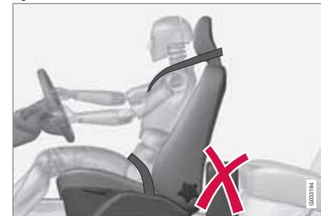
Ne placez jamais d'objets sur le plancher derrière les sièges conducteur et passager qui pourraient gêner le fonctionnement du système WHIPS.
