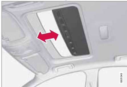
Une pression longue sur le bouton de verrouillage permet de fermer le toit ouvrant et toutes les vitres, reportez-vous aux pages 49 et 63. Les portes et le hayon sont verrouillés. Si vous devez interrompre la fermeture, appuyez à nouveau sur le bouton de verrouillage.
