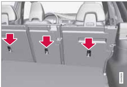
La voiture est équipée de points de fixation supérieurs pour certains modèles de sièges enfant face à la route. Ces points de fixation sont placés à l'arrière du siège.
