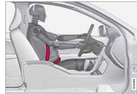
La ceinture de sécurité doit toujours être utilisée pendant la grossesse. Mais il est important de l'utiliser correctement. La ceinture de sécurité doit se coller contre l'épaule et la partie diagonale doit se placer entre les seins et sur le côté du ventre.
