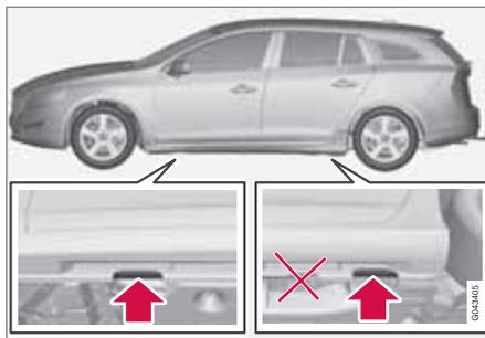
Si un cric d'atelier est utilisé pour soulever la voiture, il doit être placé sur le bord avant du cadre de moteur.
