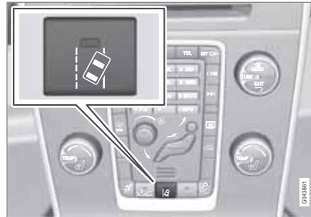
La fonction est activée et désactivée avec un interrupteur sur la console centrale. Une diode sur le bouton s'allume lorsque la fonction est activée.
