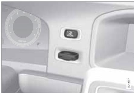
Contacteur d'allumage avec télécommande insérée et bouton **START/STOP ENGINE**.
