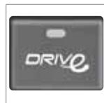
Dans certaines situations, l'utilisation du frein moteur est avantageuse, par exemple dans les descentes, et il peut donc être intéressant de désactiver temporairement la fonction Eco DRIVE en
