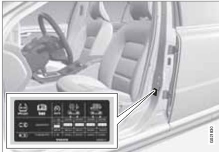
L'autocollant de pressions de pneu sur l'intérieur du montant de porte du côté conducteur (entre les portes avant et arrière) quelle pression les pneus doivent avoir à différentes conditions de charge et de vitesse. La pression correcte est aussi indiquée dans le tableau de pressions de pneu, voir page 377.
