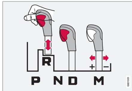
Il est possible de déplacer librement le levier de vitesses d'avant en arrière entre **N** et **D**. Les autres positions sont bloquées par un loquet
