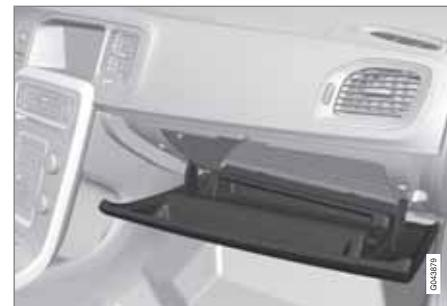
Le manuel de conduite et d'entretien et les cartes routières par exemple peuvent être rangés à cet endroit. Il y a un porte-stylo sur la face intérieure de la porte de la boîte à gants. La boîte à gants peut être verrouillée avec la lame de clé, voir page 52.
