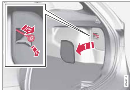
La trappe du réservoir de carburant peut être ouverte à la main lorsque l'ouverture électrique depuis l'habitacle n'est pas possible.
