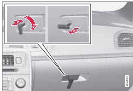
La boîte à gants ne peut être verrouillée/déverrouillée qu'à l'aide de la lame de clé de la télécommande. (Pour de plus amples informations sur la lame de clé, voir page 52).
