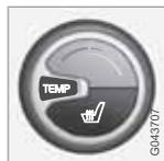
Une pression sur le bouton permet d'obtenir le niveau de chauffage maximal - trois témoins oranges sont allumés sur l'écran de la console centrale (voir illustration ci-dessus).
