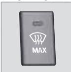
Cette fonction permet de dégivrer et de désembuer rapidement le pare-brise et les vitres latérales. L'air arrive sur les vitres. Le témoin du bouton de dégivrage s'allume lorsque la fonction est active.
