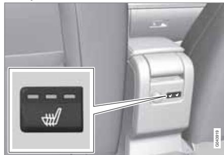
Une pression sur le bouton permet d'obtenir le niveau de chauffage maximal - trois témoins sont allumés.
