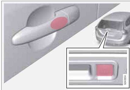
Les voitures avec système Keyless ont une zone tactile sur la poignée extérieure des portes et un bouton caoutchouté près du bouton gainé de caoutchouc du hayon.
