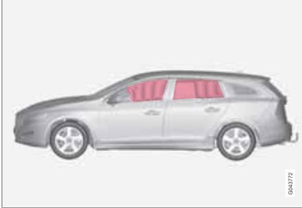
Le rideau gonflable IC (Inflatable Curtain) fait partie des systèmes de coussins gonflables et SIPS. Le rideau gonflable est dissimulé dans la garniture de plafond des deux côtés de la voiture et il protège les occupants des places extérieures. Lors d'une forte collision, les capteurs réagissent et le rideau gonflable se gonfle. Le rideau gonflable a été conçu pour empêcher la tête du conducteur et des passagers de heurter l'intérieur de la voiture en cas de collision.
