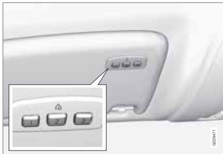
HomeLink® est une télécommande programmable qui permet de commander jusqu'à trois équipements (une porte de garage, un système d'alarme, un éclairage extérieur/intérieur par exemple) et ainsi de remplacer les télécommandes de ceux-ci. HomeLink® est livré intégré dans le pare-soleil gauche.
