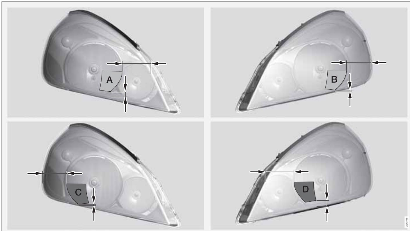
Ligne supérieure : masquage pour voiture avec conduite à gauche, modèles A et B. Ligne inférieure : masquage pour voiture avec conduite à droite, modèles C et D.
