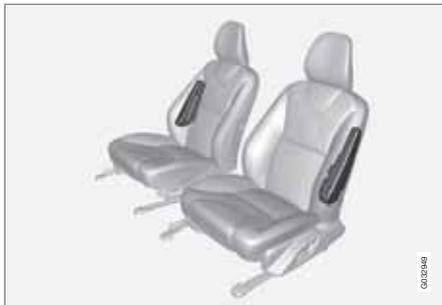
En cas de collision latérale, le SIPS (Side Impact Protection System) répartit une grande partie de l'impact de la collision dans les longerons, les montants, le plancher, le toit et les autres éléments de la carrosserie. Les coussins gonflables latéraux, du côté conducteur et du côté passager, protègent la cage thoracique et les hanches et sont des éléments importants du système SIPS.
