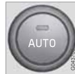
Cette fonction automatique régule automatiquement la température, l'air conditionné, la vitesse du ventilateur, la recirculation et la répartition de l'air.
