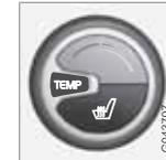
La molette permet de régler la température. Avec l'ECC\*, la température peut être réglée séparément du côté conducteur et du côté passager.
