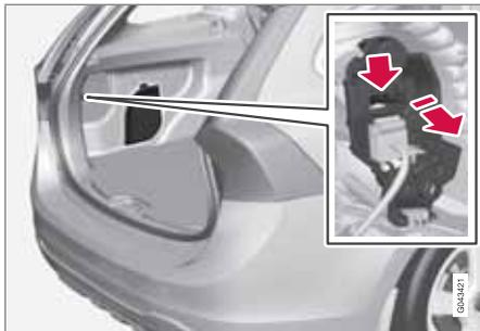
Les ampoules de clignotant, de feu antibrouillard et de feu de recul dans le combiné arrière doivent être remplacées à partir du compartiment à bagages.
