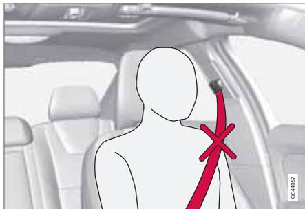
Ceinture de sécurité mal placée. La ceinture doit se trouver sur l'épaule.
