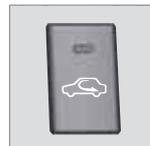
Lorsque la recirculation est activée, le témoin orange du bouton s'allume. Cette fonction est sélectionnée pour isoler l'habitacle de l'air vicié extérieur, des gaz d'échappements etc. L'air est ainsi recirculé et remis en circulation, c'est-à-dire qu'aucun air provenant de l'extérieur de la voiture n'entre dans l'habitacle lorsque la fonction est activée.
