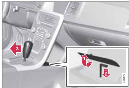
Si la voiture ne peut être conduite, par ex. lorsque la batterie est déchargée, il faudra sortir le levier sélecteur de la position **P** pour pouvoir déplacer la voiture.
