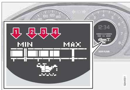
Les chiffres 1 à 4 représentent le niveau de remplissage. Ne rajoutez pas plus d'huile si le niveau de remplissage (3) ou (4) s'affiche. Le niveau de remplissage recommandé est 4.
