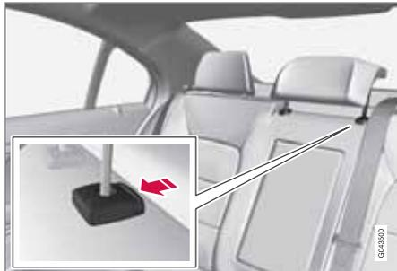
L'appuie-tête doit être réglé en hauteur selon la taille du passager. La partie centrale de l'arrière de la tête doit être au niveau du bord supérieur de l'appuie-tête. Réglez l'appuie-tête selon vos besoins.
