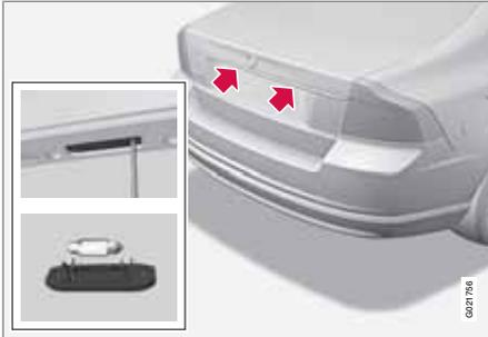
1. Desserrez les vis avec un tournevis.
