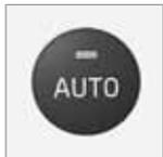
Cette fonction règle automatiquement la température, l'air conditionné, la vitesse du ventilateur, la recirculation et la répartition de l'air.
