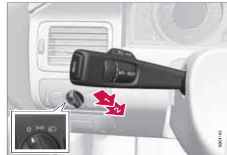
Commutateur d'éclairage et levier au volant.
