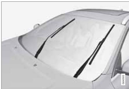
Pour pouvoir remplacer, nettoyer ou lever les balais d'essuie-glace (pour gratter la glace sur le pare-brise), ils doivent être en position d'entretien.
