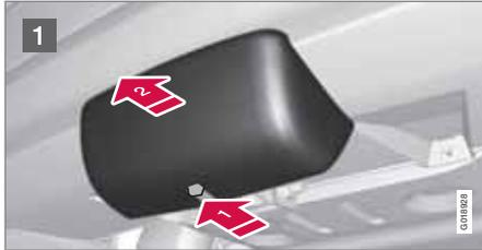
1 Déposez d'abord le cache de protection en appuyant sur le loquet **1** puis en le tirant vers l'arrière **2**.
