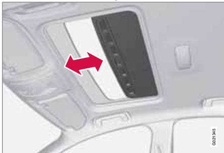
Une pression longue sur le bouton de verrouillage permet de fermer le toit ouvrant et toutes les vitres, reportez-vous aux pages 41 et 52. Les portes et le coffre à bagages sont verrouillés. Si vous devez interrompre la fermeture, appuyez à nouveau sur le bouton de verrouillage.
