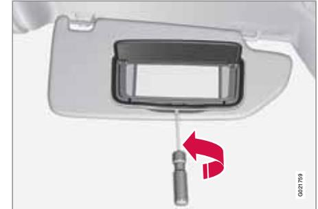
1. Insérez un tournevis sous le bord inférieur, au centre. Faites levier avec précaution sur la patte, sur le bord.
