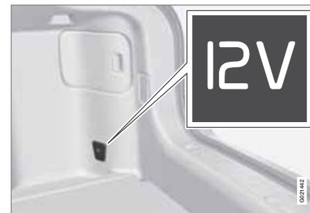
Relevez le couvercle pour accéder à la prise électrique. La prise fournit du courant même lorsque la télécommande n'est pas dans le contacteur d'allumage.
