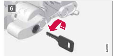
6 Tournez la clé dans le sens inverse des aiguilles d'une montre jusqu'en position de verrouillage. Retirez la clé de la serrure.
