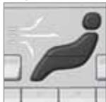
La figure est composée de trois boutons. En appuyant sur le boutons, un témoin s'allume devant chaque partie de la figure, indiquant la répartition de l'air sélectionnée, voir page 142.
