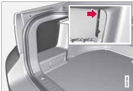
Ce boîtier se trouve derrière la trappe gauche du compartiment à bagages
