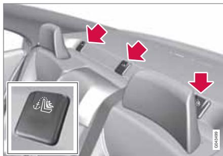
La voiture est équipée de points de fixations supérieure pour sièges enfant. Ces points de fixation sont placés sur la plage arrière et cachés par des caches en plastique. Retirez
