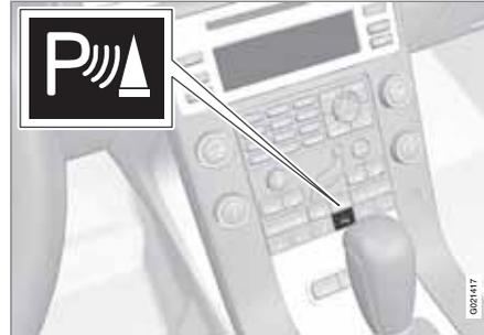
Le système est automatiquement activé au démarrage de la voiture et la diode de l'interrupteur de marche/arrêt s'allume. Si l'aide au stationnement est désactivée avec le bouton, la diode s'éteint.
