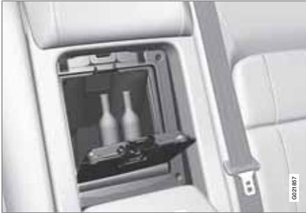
L'accoudoir de la banquette arrière cache un réfrigérateur. Le réfrigérateur fonctionne lorsque le moteur tourne ou si la télécommande est en position II.
