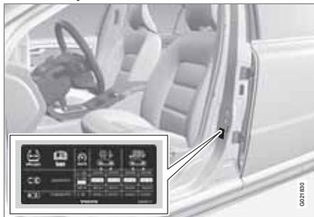
L'autocollant de pressions de pneu sur l'intérieur du montant de porte du côté conducteur (entre les portes avant et arrière) quelle pression les pneus doivent avoir à différentes conditions de charge et de vitesse. La pression correcte est aussi indiquée dans le tableau de pressions de pneu, voir page 313.
