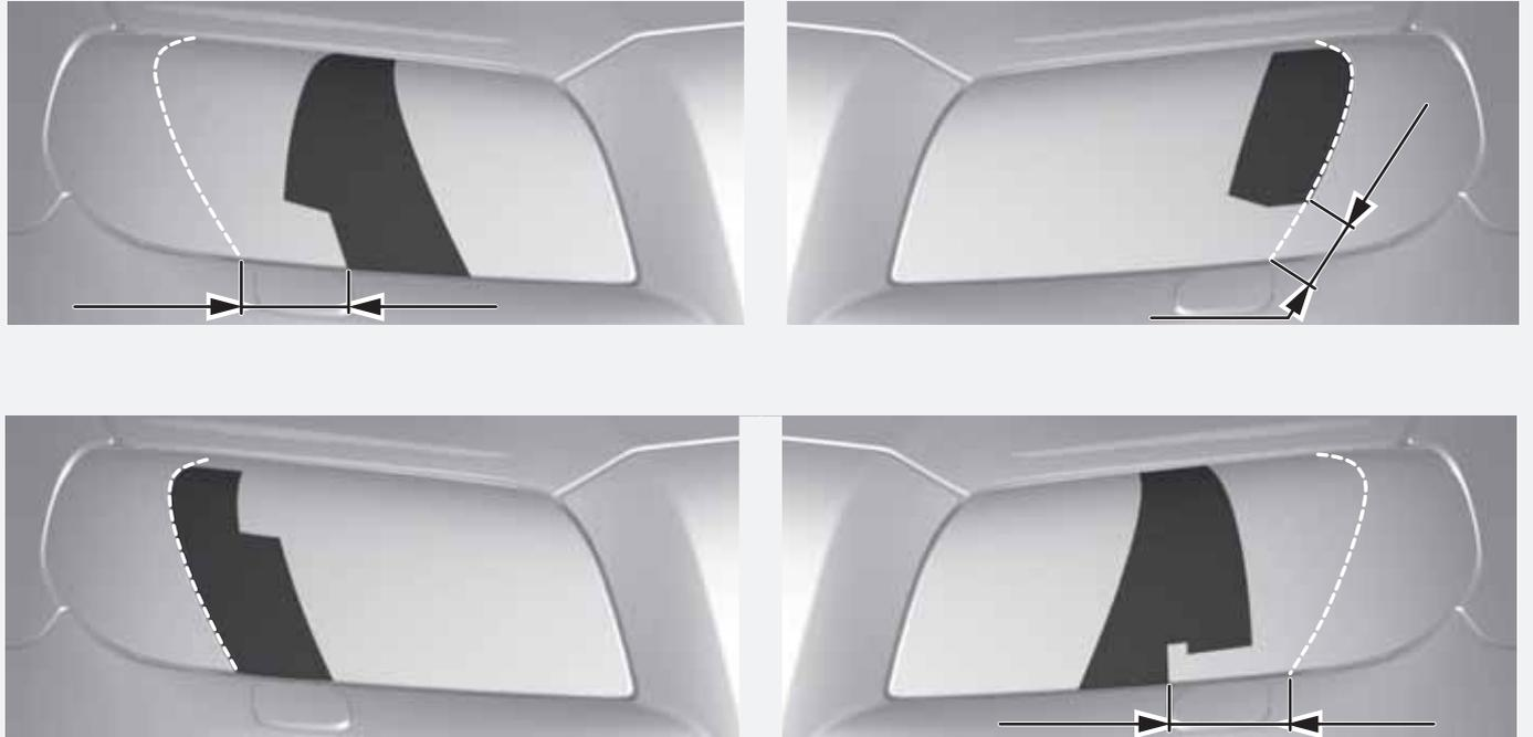
Ligne supérieure : masquage pour voiture avec conduite à gauche, modèles A et B. Ligne inférieure : masquage pour voiture avec conduite à droite, modèles C et D.
