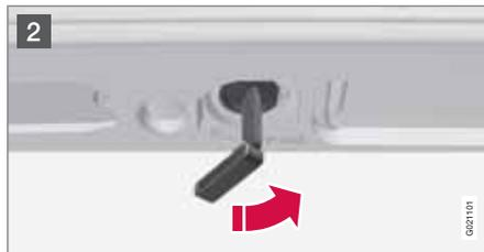
Le coffre à bagages peut être ouvert manuellement avec lame de clé si la batterie de la voiture était déchargée. Le coffre à bagages ne peut alors plus être ouvert avec le bouton du panneau de commande d'éclairage.
