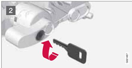
2 Vérifiez que le mécanisme est en position déverrouillée en tournant la clé dans le sens des aiguilles d'une montre.
