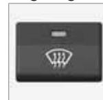
Cette fonction permet de dégivrer et de débarrasser rapidement le pare-brise et les vitres latérales. L'air arrive sur les vitres. Le témoin du bouton de dégivrage s'allume lorsque la fonction est active.
