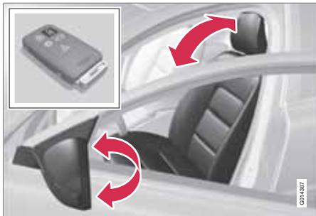
Lorsque la voiture est déverrouillée avec la télécommande qui a servi à la verrouiller, le siège conducteur et les rétroviseurs extérieurs reprennent les positions mémorisées dans la mémoire clé dès l'ouverture de la porte conducteur.
