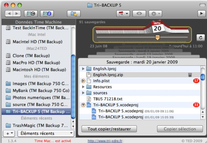
Back-In-Time recherche dans le ou les disques Time Machine les données correspondant à l'élément sélectionné et reconstitue l'historique des contenus sauvegardés. Les données enregistrées par Time Machine sont affichées sous forme de liste.
