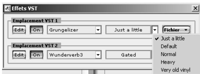
À chaque fois que vous sélectionnez un plug-in, le programme charge la liste de droite qui contient une sélection standard de pré-réglages, également appelés *Programmes*. Chaque programme représente une combinaison de réglages pour le plug-in sélectionné.
