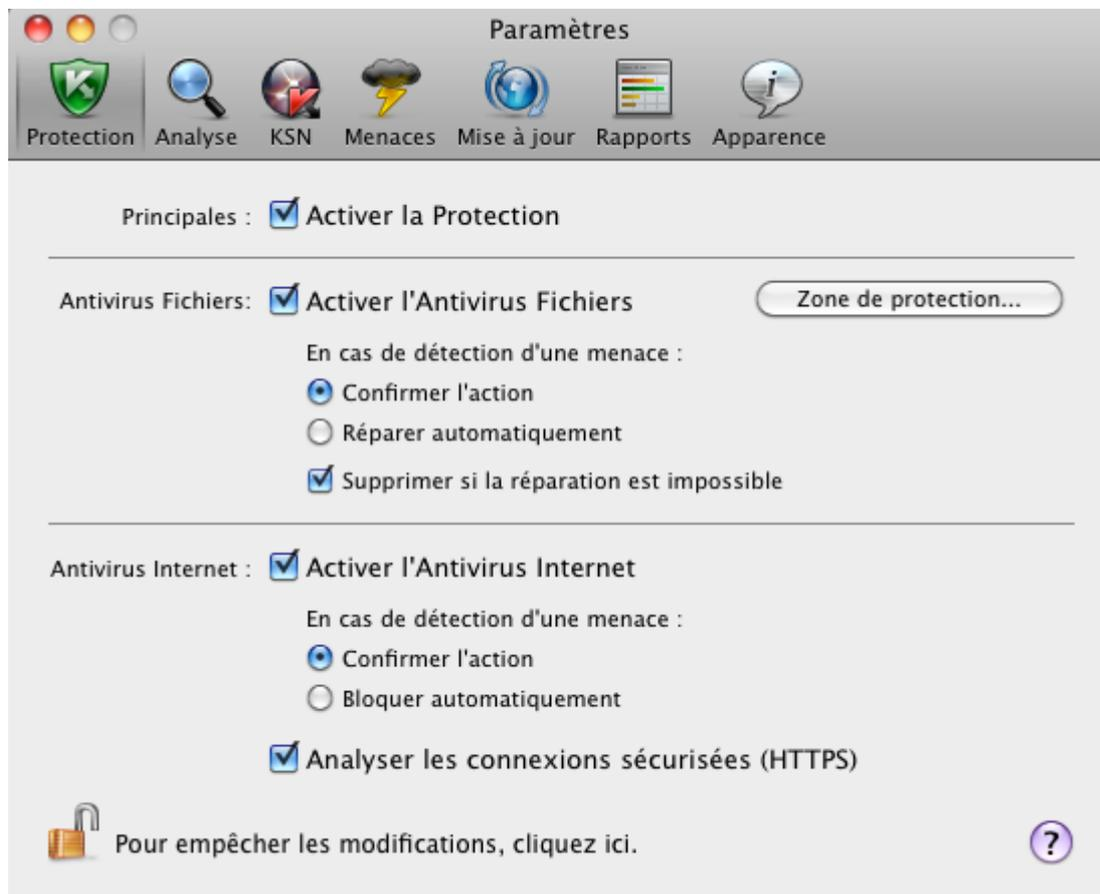
Illustration 3. Fenêtre de configuration de l'application. Onglet Protection
