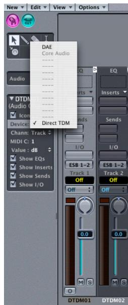
S'il n'existe aucune console dans votre Modèle Autoload, générez-en une pour le matériel DTDM virtuel. Pour de plus amples informations, voir "Générer une console audio" à la page 20.
