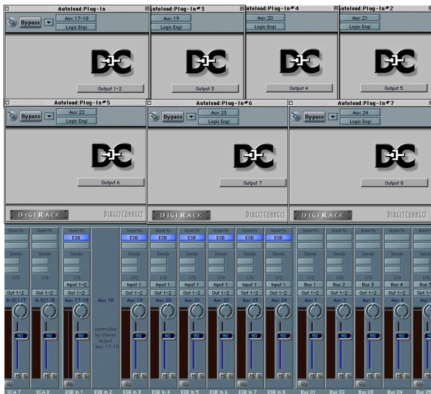
Dans la fenêtre du plug-in ESB TDM, vous pouviez sélectionner la voie de sortie désirée de la console DTDM (Sortie 1–8). Les plug-ins ESB TDM insérés dans les Objets Aux stéréo pouvaient aussi sortir sur des paires de voies, 1–2, 3–4, 5–6 et 7–8.
