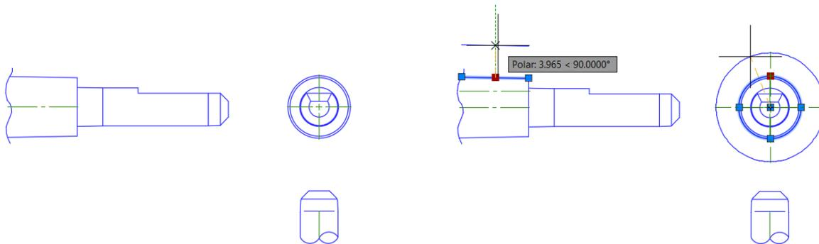
Vous pouvez dissocier des traits d'axe et des points de centre des objets à l'aide de la commande CENTREDISSOCIER. Utilisez la commande CENTREREASSOCIER pour réassocier des traits d'axe et des points de centre avec les objets sélectionnés.
