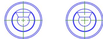
CENTERCROSSGAP : détermine l'espacement de la ligne d'attache entre la croix centrale et les lignes d'attache des points de centre.
