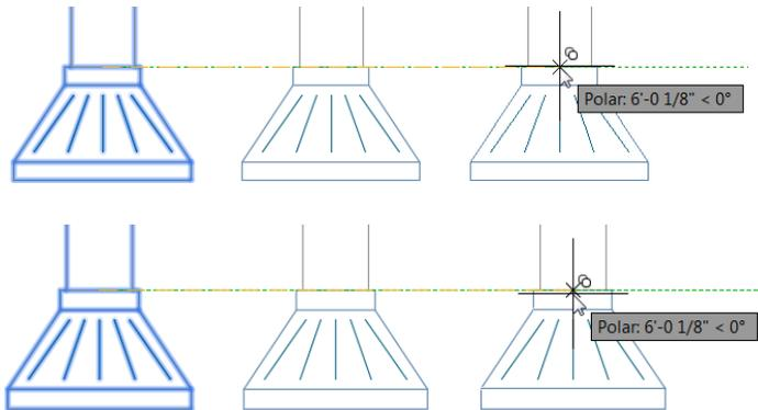
Dans les versions précédentes d'AutoCAD, les types de ligne POINT pouvaient être difficiles à voir, même après application des épaisseurs de ligne. AutoCAD 2017 prend désormais en charge l'affichage de l'épaisseur de ligne pour ces types de ligne, comme illustré.
