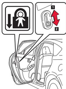
Ce verrouillage peut être activé pour empêcher les enfants d'ouvrir les portes arrière. Poussez les contacteurs de porte arrière vers le bas pour les verrouiller.
