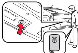
Appuyez sur le bouton de verrouillage pour verrouiller le hayon.
