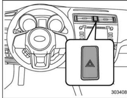
Les feux de détresse s'utilisent pour signaler à l'attention des autres conducteurs la présence d'un véhicule en difficulté. Les feux de détresse fonctionnent indépendamment de la position du contacteur d'allumage.
