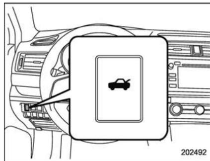
Maintenez la commande d'ouverture du coffre à bagages appuyée pendant plus d'une seconde.
