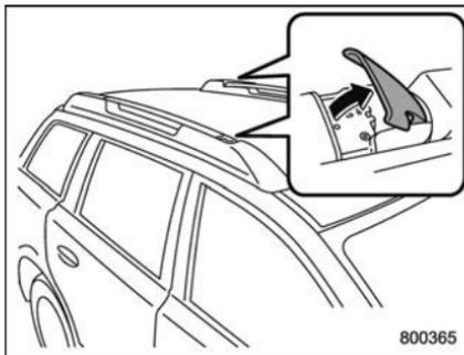
1. Sortez les traverses intégrées des supports de rail de toit en soulevant les couvercles.
