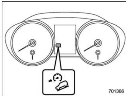
Cet indicateur apparaît lorsque la fonction de contrôle de vitesse en descente est en mode d'attente. Il clignote lorsque la fonction est active. Il disparaît lorsque la fonction est en mode désactivé. Lorsque cette fonction passe de l'état opérationnel à l'état non-opérationnel, il disparaît lorsque la vitesse du véhicule devient supérieure à environ 30 km/h (18 mph).
