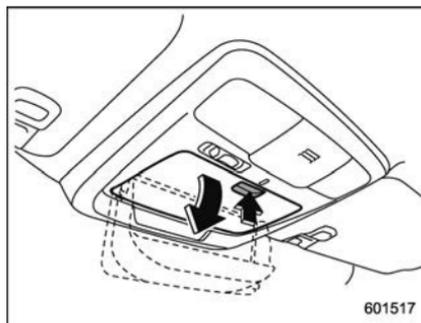
Pour ouvrir la console, appuyez légèrement sur le couvercle et il s'ouvrira automatiquement.
