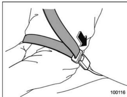
1. Pour détacher la ceinture de sécurité, appuyez sur le bouton de déblocage de la boucle de la ceinture de sécurité centrale (sur le côté gauche).
