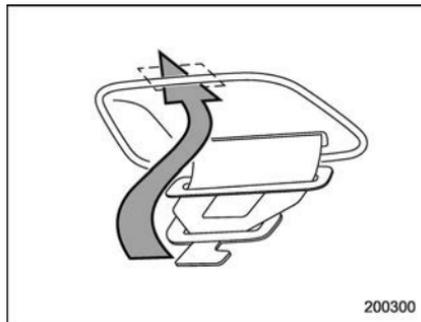
3. Laissez la sangle s'enrouler dans l'enrouleur. Orientez convenablement la sangle pour que la languette vienne se ranger dans l'enrouleur. Rangez soigneusement la languette dans le renforcement du plafond, puis introduisez le connecteur (languette) dans la fente.
