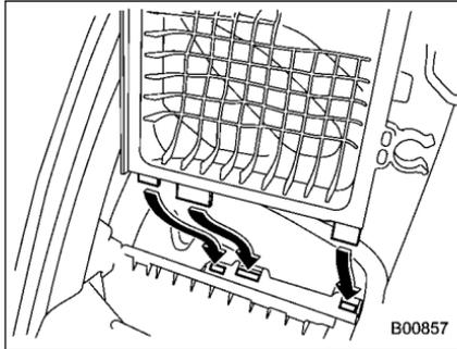
6. Pour installer le boîtier de filtre à air (arrière), introduisez les trois taquets du boîtier de filtre à air (arrière) dans les encoches du boîtier de filtre à air (avant).
