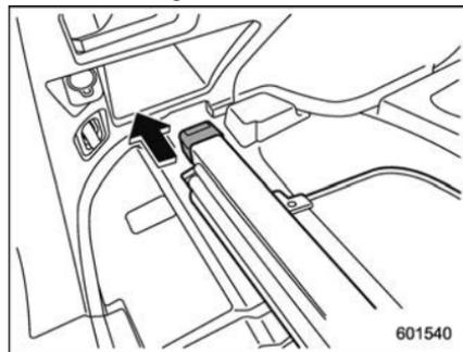
5. Insérez l'extrémité gauche du logement du cache dans la pièce de retenue.
