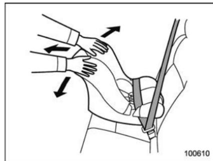
6. Poussez et tirez le système de retenue pour enfant dans le sens avant-arrière et sur les côtés, pour vous assurer qu'il est fermement fixé au centre du siège. Un système de retenue pour enfant est souvent maintenu plus fermement si on l'enfonce le plus possible sur le coussin de siège avant de serrer la ceinture de sécurité.
