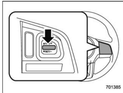
2. Appuyez sur le bouton "RES/SET" une fois sur le côté "SET" et relâchez-le. Le système est maintenant réglé sur la vitesse souhaitée et le véhicule roule à cette vitesse sans qu'il soit nécessaire d'appuyer sur la pédale d'accélérateur.
