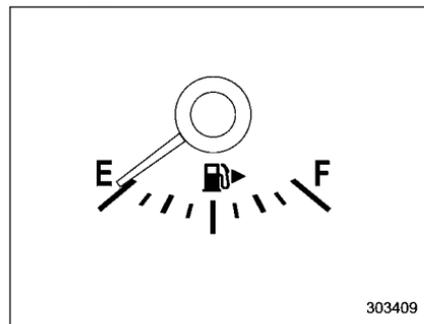
La jauge de carburant indique la quantité approximative de carburant dans le réservoir.
