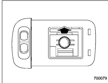
2. Sortez l'ampoule de la douille en tirant.
