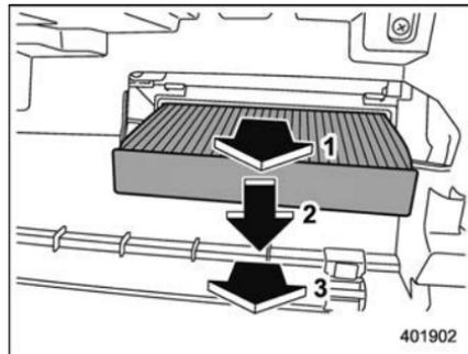
3. Déposez le filtre à air en suivant la
