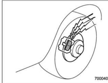
Les indicateurs d'usure des plaquettes des freins à disque émettent un bruit caractéristique pour vous avertir quand les plaquettes sont usées.
