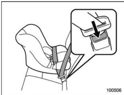
8. Pour enlever le système de retenue pour enfant, appuyez sur le bouton de déblocage de la boucle de ceinture de sécurité et enrroulez complètement la sangle dans l'enrouleur. L'enrouleur repasse en mode ELR.
