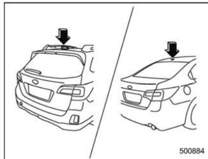
L'antenne radio satellite et l'antenne de télématique (selon modèles) sont installées dans le centre du toit à l'arrière.
