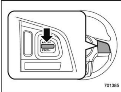
2. Une fois la vitesse réduite au niveau souhaité, appuyez une fois sur le bouton “RES/SET” sur le côté “SET”. Le système est maintenant réglé sur la vitesse souhaitée et le véhicule roule à cette vitesse sans qu’il soit nécessaire d’appuyer sur la pédale d’accélérateur.
