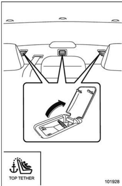
Il y a trois ancrages de longe installés sur la plage arrière derrière l'appui-tête du siège arrière. Ouvrez le volet pour utiliser
