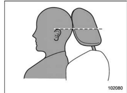
Chaque appui-tête doit être réglé de sorte que le centre de l'appui-tête soit au niveau du haut des oreilles de l'occupant du siège.
