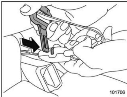
2. Pour séparer la plaque du connecteur (languette) du côté droit, introduisez une languette ou d'autres objets pointus dans la fente du connecteur (boucle).
