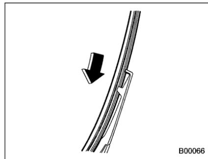
4. Engagez les ergots du support en plastique dans les rainures du caoutchouc du balai, puis glissez le caoutchouc en place jusqu'au bout.
