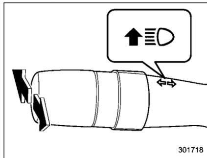
Pour passer des feux de croisement aux feux de route, poussez la manette des clignotants de direction vers l'avant. Lorsque les phares sont en position de feux de route, le témoin indicateur des feux de route "☰●" situé sur les instruments de bord s'allume également. Pour revenir en position de feux de croisement, tirez la manette en arrière jusqu'à la position centrale.
