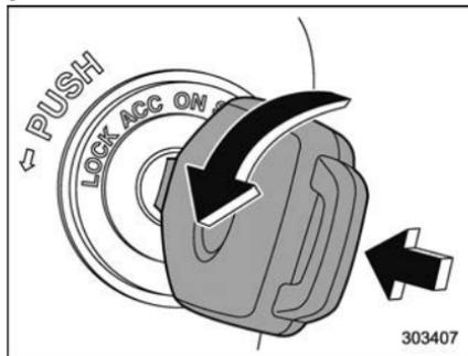
La clé ne peut être tournée de la position "ACC" à "LOCK" que lorsque la clé est poussée tout en la tournant (tous les modèles) et que le levier sélecteur est en position "P" (modèles CVT).
