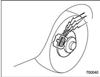
Les freins à disque sont équipés d'indicateurs sonores d'usure sur les plaquettes de frein. Si l'usure des plaquettes de frein est proche de la limite de service, ces indicateurs émettent un couinement caractéristique et bien audible lorsque vous appuyez sur la pédale de frein.
