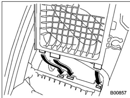
5. Pour installer le boîtier de filtre à air (arrière), introduisez les trois taquets du boîtier de filtre à air (arrière) dans les encoches du boîtier de filtre à air (avant).
