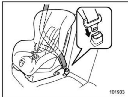
5. Passez la sangle-baudrier et la sangle sous-abdominale au travers et autour du système de retenue pour enfant en suivant les instructions du fabricant de ce système.
