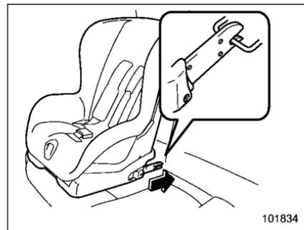
1. En suivant les instructions fournies par le fabricant du système de retenue pour enfant, fixez les crochets inférieurs aux ancrages inférieurs à l'endroit des marques "C" en bas du dossier du siège arrière. En accrochant les crochets, veillez à ne pas prendre les ceintures de sécurité voisines.
