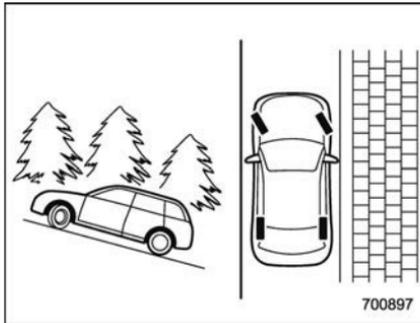
Pour le stationnement en côte, orientez les roues correctement comme indiqué ici. Si le véhicule est dans le sens de la montée, les roues avant doivent être braquées comme pour s'éloigner du trottoir.
