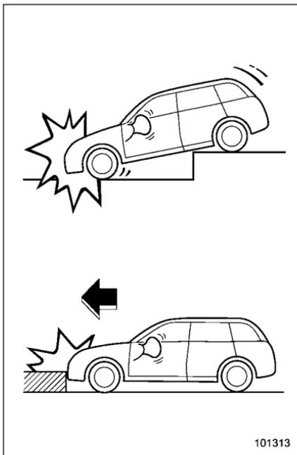
Le coussin de sécurité frontal SRS du conducteur seulement ou les coussins de sécurité frontaux SRS du conducteur et du passager avant peuvent être actionnés si le soubassement du véhicule subit un fort impact par le bas (comme lorsque le véhicule tombe dans un fossé profond ou heurte violemment un obstacle tel qu'une bordure de trottoir).
