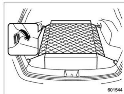
L'espace de chargement est équipé de quatre crochets d'arrimage pour maintenir la charge immobile au moyen d'un filet à bagages ou de cordes.
