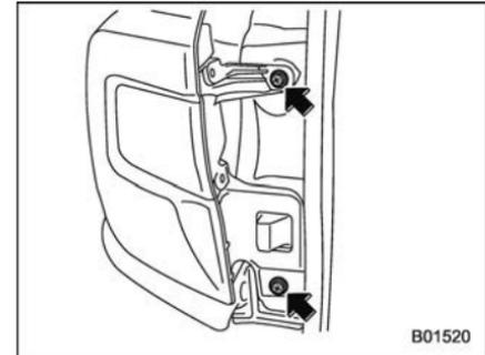
9. Serrez les vis de fixation en haut et en bas.
