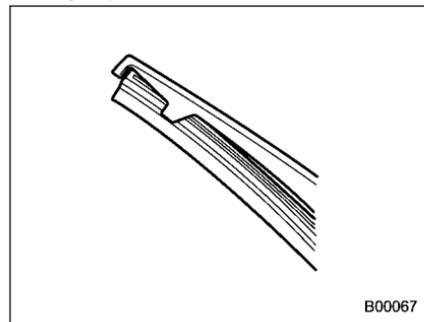
Immobilisez soigneusement les extrémités du caoutchouc dans les butées sur le
