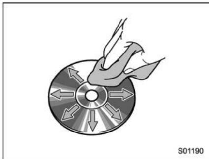
**Pour nettoyer un disque:** Essuyez-le avec un chiffon doux non pelucheux humecté d'eau. Essayez en dessinant une ligne droite du centre vers le bord du disque (pas en cercles). Séchez-le avec un autre chiffon doux non pelucheux. N'utilisez pas de nettoyant pour disque conventionnel ou de dispositif antistatique.
