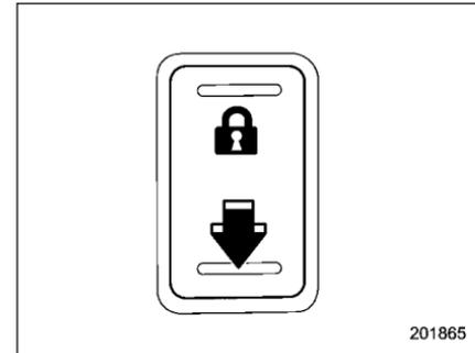
2. Appuyez sur le côté arrière (côté déverrouillage) du commutateur de verrouillage électrique des portières.
