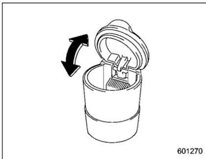
Le cendrier portable peut être installé dans chaque porte-gobelet. Pour des informations relatives à l'emplacement des porte-gobelets, reportez-vous à "Porte-gobelet" ¶ 6-8. Lorsque vous utilisez le cendrier, ouvrez son couvercle. Pour retirer le cendrier d'un porte-gobelet, tirez le cendrier vers le haut.
