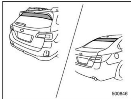
L'antenne est imprimée sur la face intérieure de la lunette arrière.
