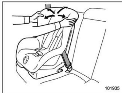
9. Avant d'asseoir un enfant dans le système de retenue pour enfant, essayez de le déplacer d'avant en arrière et de droite à gauche pour vous assurer qu'il est fermement maintenu au centre du siège. Un système de retenue pour enfant est souvent maintenu plus fermement si on l'enfonce le plus possible sur le coussin de siège avant de serrer la ceinture de sécurité.
