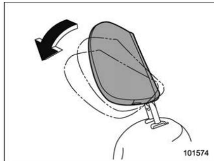
L'angle de l'appui-tête peut être réglé en plusieurs étapes. Tout en maintenant une position de conduite appropriée, réglez l'appui-tête sur une position dans laquelle l'arrière de votre tête est le plus proche possible de l'appui-tête.
