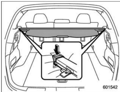
1. Insérez les deux extrémités de l'ensemble rideau et enrouleur dans les points de fixation.
