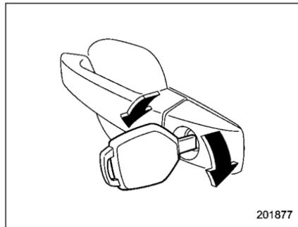
Pour verrouiller la portière conducteur par l'extérieur au moyen de la clé, tournez la clé vers l'avant.
