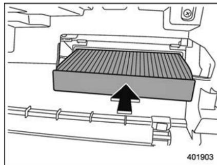
4. Remplacez l'élément du filtre à air par un neuf.
