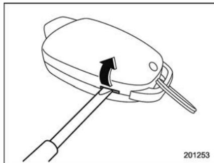
2. Faites lever et détachez soigneusement les deux moitiés du transmetteur de démarrage à distance du moteur à l'aide d'un petit tournevis à lame plate.
