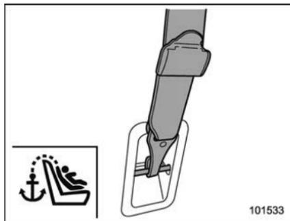
4. Attachez le crochet de la longe supérieure sur l'ancrage supérieur approprié.
