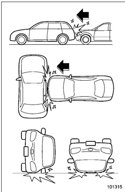
Les coussins de sécurité frontaux SRS du conducteur et du passager avant sont conçus pour ne pas se déployer dans la plupart des cas si le véhicule est heurté par le côté ou par l'arrière, s'il se renverse sur le flanc ou sur le toit, ou s'il est impliqué dans une collision frontale à petite vitesse.
