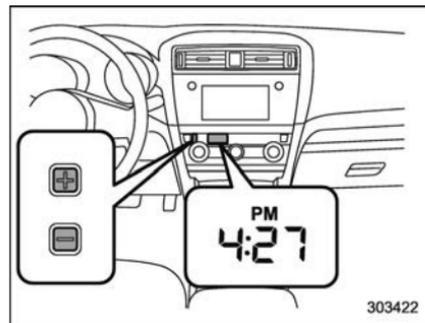
L'horloge indique l'heure lorsque le contacteur d'allumage est en position "ACC" ou "ON".
