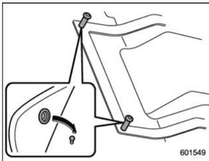
Le plancher côté conducteur est équipé d'ergots de fixation.
