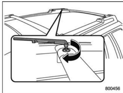
6. Serrez le boulon de la traverse en utilisant la clé dynamométrique. Le couple
