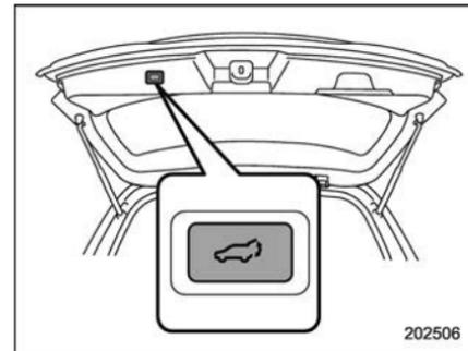
**Bouton de hayon électrique sur le bord intérieur du hayon**
