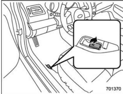
2. Pour ouvrir le volet de remplissage du carburant, tirez le levier d'ouverture vers le haut. Le levier d'ouverture se trouve sur le plancher, sur la gauche du siège du conducteur.
