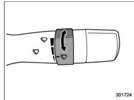
Lorsque la commande d'essuie-glace est en position "⚡", tournez la molette pour régler la fréquence de balayage d'essuie-glace. L'intervalle de balayage peut être ajusté sur plusieurs niveaux, de l'intervalle le plus court jusqu'au plus long.
