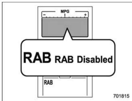
En cas de dysfonctionnement du système de freinage automatique en marche arrière, l'indicateur ci-dessus s'allume dans les instruments de bord. Pour plus de détails, adressez-vous à votre concessionnaire SUBARU le plus proche.
