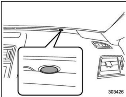
Le capteur est situé sur le tableau de bord comme indiqué sur l'illustration.
