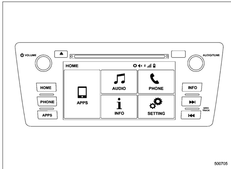
L'équipement audio ne fonctionne que lorsque le contacteur d'allumage est en position "ACC" ou "ON".
