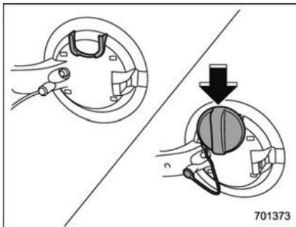
5. Placez le bouchon du réservoir sur le support situé à l'intérieur du volet de remplissage de carburant.
