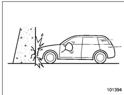
Une collision frontale contre un épais mur de béton avec une vitesse du véhicule de l'ordre de 20 à 30 km/h (12 à 19 mph) ou plus actionnera le coussin de sécurité frontal SRS du conducteur seulement ou les deux coussins de sécurité frontaux SRS du conducteur et du passager avant. Le coussin de sécurité est aussi activé lorsque le véhicule subit un choc par l'avant du même genre et de la même intensité que la collision indiquée ci-dessus.
