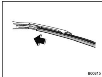
3. Placez les griffes du support en face des rainures du caoutchouc, puis faites glisser le caoutchouc dans le support jusqu'à ce qu'il se verrouille en position.
