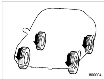
La traction intégrale répartit la force motrice entre les quatre roues du véhicule. Les véhicules AWD présentent une meilleure traction pour la conduite sur route glissante, mouillée ou verglacée, et pour dégager le véhicule enlisé dans la boue ou le sable. En répartissant de façon optimale la force motrice entre les roues
