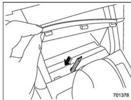
5. En appuyant sur la pédale de frein, insérez le tournevis dans l'orifice, appuyez sur la partie de déverrouillage du levier de changement de vitesses avec le tournevis, puis déplacez le levier sélecteur.
