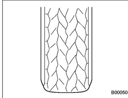
La tenue de route et le contrôle de la direction sont bons. La résistance au roulement est faible, ce qui réduit la consommation de carburant.
