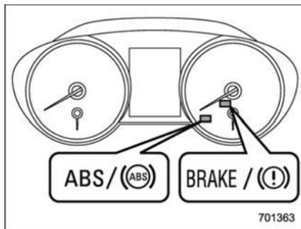
En cas de défaut de fonctionnement du système EBD, le système cesse de fonctionner et le témoin avertisseur du système des freins et le témoin avertisseur des freins antiblocage ABS s'allument simultanément.
