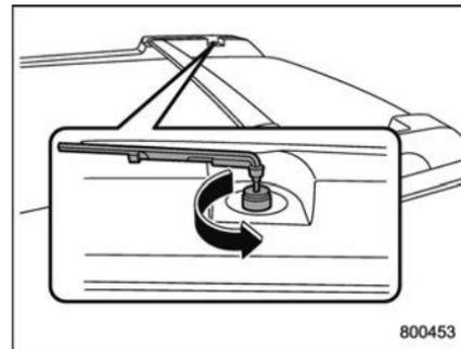
2. Détachez l'amorce du support de rail de toit en utilisant la clé dynamométrique.
