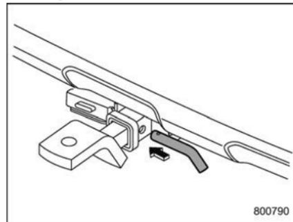
2. Introduisez la goupille d'attelage dans le trou situé sur le tube de tête d'attelage de telle manière que la goupille d'attelage traverse la fixation à boule.
