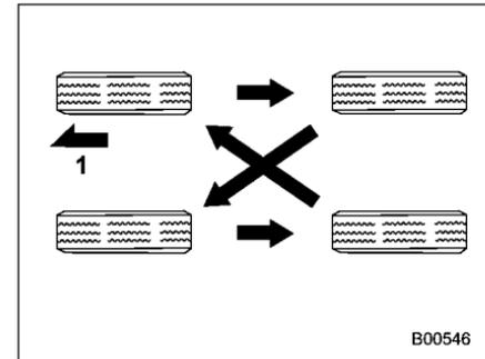
Véhicules équipés de 4 pneus non unidirectionnels
