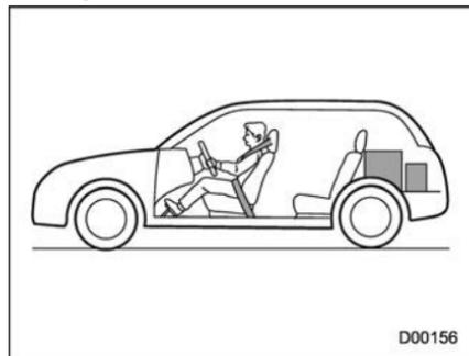
La capacité de charge du véhicule est de 363 kg (800 lbs), ce qui est indiqué sur la plaque du véhicule qui porte la mention "Le total du poids des occupants et du poids du chargement ne doit jamais dépasser 363 kg ou 800 lbs".
