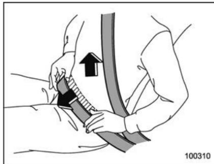
6. Pour tendre la sangle sous-abdominale, tirez sur la sangle-baudrier. Placez la sangle sous-abdominale le plus bas possible sur le bassin, et non pas à hauteur de la taille.
