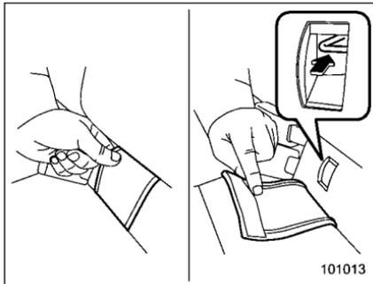
Retirez la protection de l'ancrage du côté du dossier de siège arrière choisi pour l'installation pour pouvoir accéder aux ancrages (barres) sur laquelle se fixe le système de retenue pour enfant.
