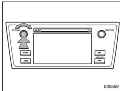
Appuyez sur la molette power/VOLUME pour allumer et éteindre le système audio/visuel. Lorsque le système s'allume, le mode utilisé à la dernière extinction du système s'affiche. Maintenez enfoncée la molette pour éteindre l'écran. Tournez cette molette pour régler le volume.
