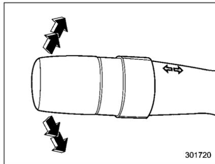
Pour signaler un virage à droite, poussez la manette des clignotants de direction vers le haut. Pour signaler un virage à gauche, poussez la manette vers le bas. La manette revient automatiquement en position centrale en sortie de virage. Si la manette ne revient pas d'elle-même en sortie de virage, ramenez-la manuellement au point mort.
