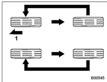
**Véhicules équipés de pneus unidirectionnels**
