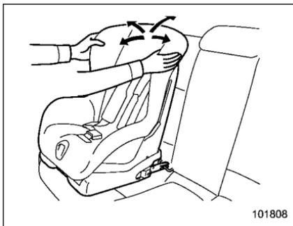
4. Avant d'asseoir un enfant dans le système de retenue pour enfant, essayez de le déplacer d'avant en arrière et de droite à gauche pour vous assurer qu'il est fermement maintenu au centre du siège.
