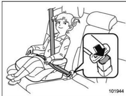
4. Pour enlever le siège rehausseur, appuyez sur le bouton de déblocage de la boucle de ceinture de sécurité pour enrouler la ceinture.
