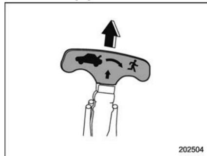
Pour ouvrir le coffre à bagages de l'intérieur, tirez sur la poignée jaune, comme l'indique la flèche sur la poignée. Cette action a pour effet de déverrouiller le coffre à bagages. Il suffit ensuite de pousser pour ouvrir le coffre à bagages.
