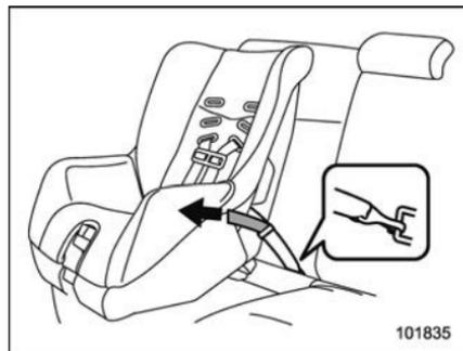
2. Si votre système de retenue pour enfant est de type à fixation souple (avec lequel le système de retenue pour enfant se fixe aux ancrages inférieurs au moyen de longues), tout en enfonçant le siège pour enfant dans le coussin de siège, tirez les deux longues inférieures pour supprimer le mou et immobiliser le système de retenue pour enfant.
