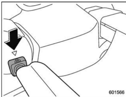
2. Assurez-vous d'attacher la partie avant de la couverture de l'espace de chargement derrière le siège arrière.
