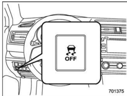
Appuyer sur la commande de désactivation du Contrôle de Dynamique du Véhicule désactive le système de Contrôle de Dynamique du Véhicule.
