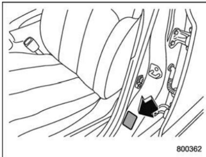
La plaque du véhicule est fixée contre le montant B, du côté du conducteur.
