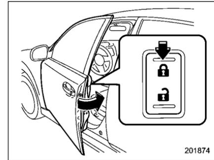
6. Appuyez sur le côté avant du commutateur (côté "LOCK") de verrouillage électrique des portières pour verrouiller les portières.
