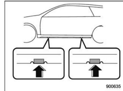
9. Placez le cric sous le bas de marche, au point de levage avant ou arrière le plus proche du pneu crevé.
