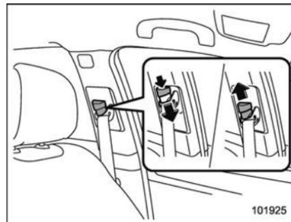
La hauteur de l'ancrage de la sangle-baudrier doit être réglée à la position qui convient le mieux au conducteur/passager avant. La hauteur de l'ancrage de ceinture doit toujours être réglée de sorte que la sangle-baudrier se trouve au milieu de l'épaule sans toucher le cou.
