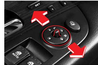
1. Sélectionner le rétroviseur du côté gauche (L) ou droit (R) au moyen du commutateur de sélection de rétroviseur.
