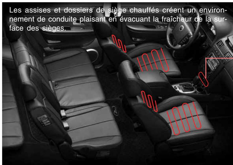
Les assises et dossiers de siège chauffés créent un environnement de conduite plaisant en évacuant la fraîcheur de la surface des sièges.
