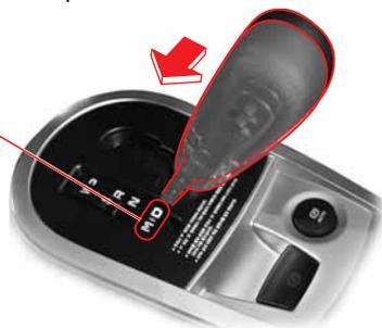
Si le levier sélecteur est déplacé en M en roulant, le rapport inférieur suivant est sélectionné.
