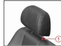
Pour lever l'appuie-tête, tirez vers le haut sans appuyer sur le bouton de déverrouillage. Pour abaisser l'appuie-tête, pressez le bouton de déverrouillage (1) placé au sommet du dossier du siège et poussez l'appuie-tête vers le bas.
