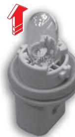
5. Déposez l'ampoule.
