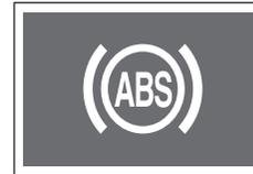
Ce témoin s'allume quand le commutateur d'allumage est sur "ON" et doit s'éteindre si le système est normal.
