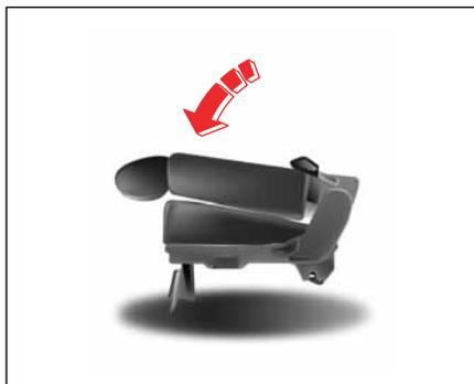
3. Appuyer sur la partie supérieure du dossier pour l'engager avec l'assise de siège.
