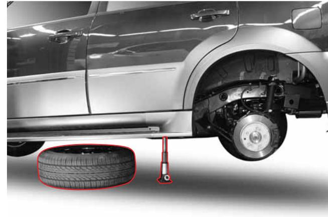
6. Extrayez la roue et placez-la sous la carrosserie du véhicule. Ceci minimisera le danger si le cric se déplace.
