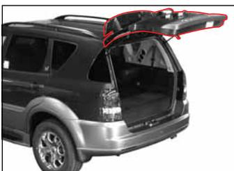
Pour ouvrir le hayon, déverrouillez le hayon et tirez le levier d'ouverture du hayon vers le haut.
