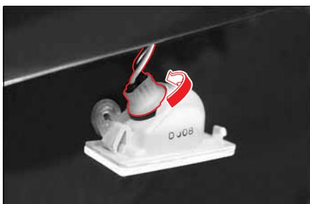
3. Déposez le logement de lampe en faisant tourner le connecteur.
