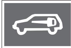
Ce témoin s'allume quand la clé de contact est en communication avec l'unité de commande du moteur (ECU) (pendant le démarrage du moteur) pendant 0,5 seconde.
