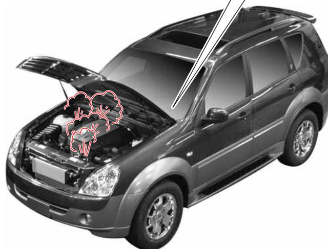
Quand le moteur surchauffe, de la vapeur peut s'échapper du compartiment moteur. Ou, l'indicateur de température du liquide de refroidissement du moteur est fermé sur H. Dans ce cas, le témoin de surchauffe du moteur s'allume et un vibreur retentit. Arrêtez immédiatement en lieu sûr.
