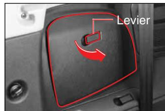
Le cric se trouve derrière le garnissage du côté gauche, à côté du siège de 3ème rangée.
