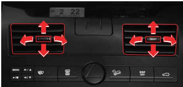
Vous pouvez régler la direction du flux d'air en déplaçant le bouton horizontalement ou verticalement.
