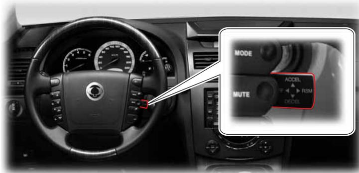
La régulation de vitesse est un système de commande automatique de la vitesse du véhicule qui maintient une vitesse désirée sans utiliser la pédale d'accélérateur.
