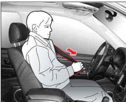
1. Retirez la plaque de verrouillage de l'enrouleur. Si la sangle se bloque quand elle est tirée, rembobinez-la complètement dans l'enrouleur, et tirez-la ensuite à la longueur désirée.
