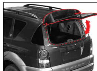
Pour déverrouiller la vitre du hayon, déverrouiller le hayon et tirer le levier de gauche vers le haut. Ouvrir la vitre du hayon en levant sa poignée extérieure.
