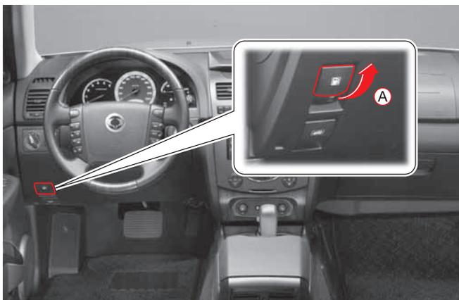
1. Ouvrir la trappe de remplissage de carburant (B) en tirant le levier de déverrouillage (A) situé sur le côté inférieur gauche du volant.
