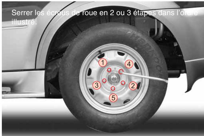
7. Montez ensuite la roue de secours et serrez temporairement les écrous de roue.
