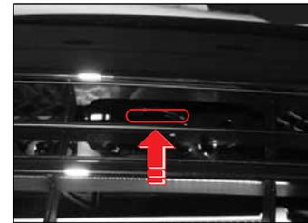
2. Lever légèrement le capot puis lever le levier de verrou de sûreté avec les doigts. Ensuite, lever le capot complètement.
