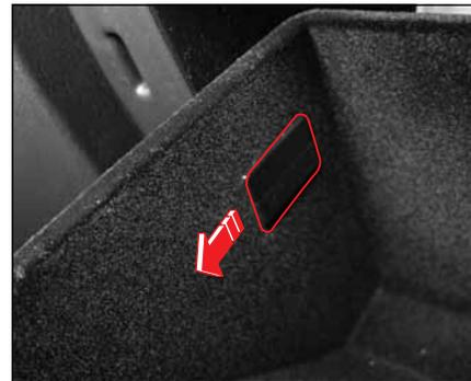
2. Déposer la boîte à gants du tableau de bord en déplaçant ses deux fixations dans le sens de la flèche.
