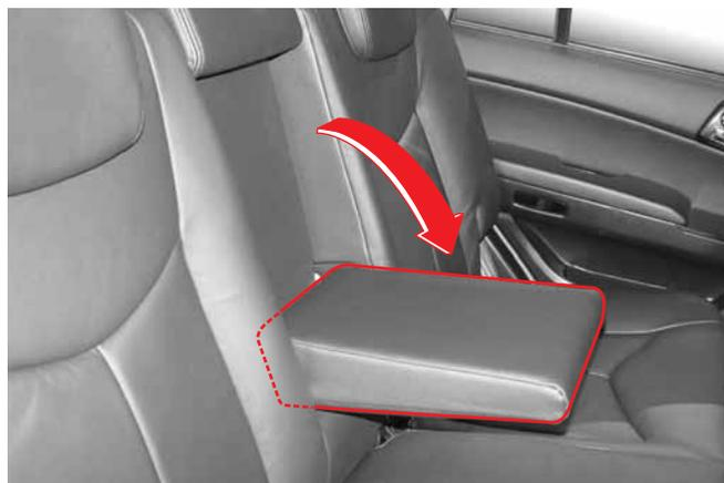
L'accoudeur arrière se trouve au centre du siège arrière. Baissez l'accoudeur pour l'utiliser. Sinon rangez-le.
