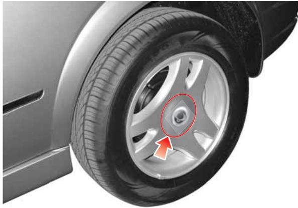
1. Retirez le chapeau de roue au moyen d'un tournevis à lame plate.
