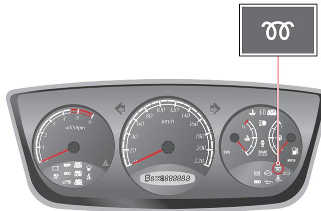
Quand le commutateur de contact est mis sur "ON", cet indicateur s'allume et reste allumé un court instant ou peut s'éteindre aussitôt. Quand les bougies de préchauffage sont suffisamment réchauffées, le témoin s'éteint. En cas d'injection directe, ce témoin peut s'allumer très brièvement ou ne pas s'allumer du tout.
