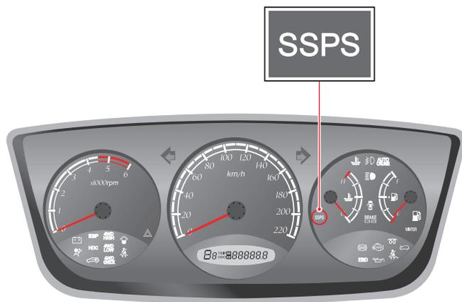
Ce témoin alerte s'allume quand le système SSPS est défaillant. Quand ce témoin s'allume, l'effort de direction devient important.
