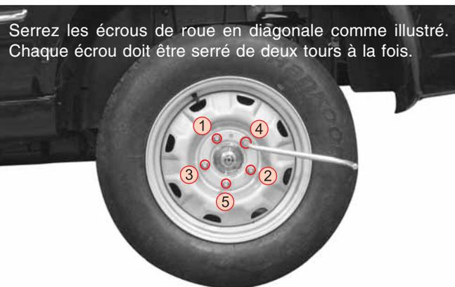
7. Montez ensuite la roue de secours et serrez temporairement les écrous de roue.
