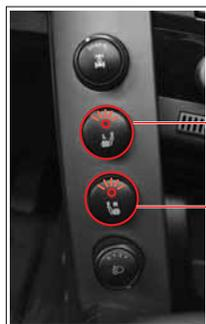
**Commutateur de chauffage du siège conducteur**
