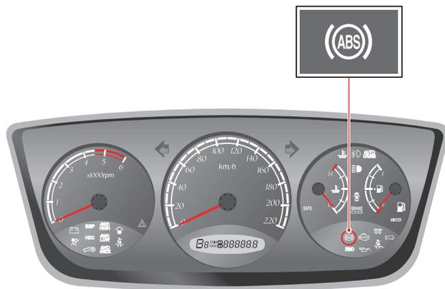
Ce témoin s'allume quand le commutateur d'allumage est sur "ON" et doit s'éteindre si le système est normal.
