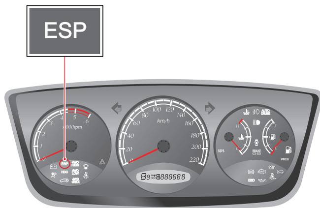
Si vous appuyez sur le commutateur ESP<sub>OFF</sub>, la fonction ESP s'arrête et le témoin du panneau d'instruments s'allume. Si l'ESP fonctionne, le témoin clignote.
