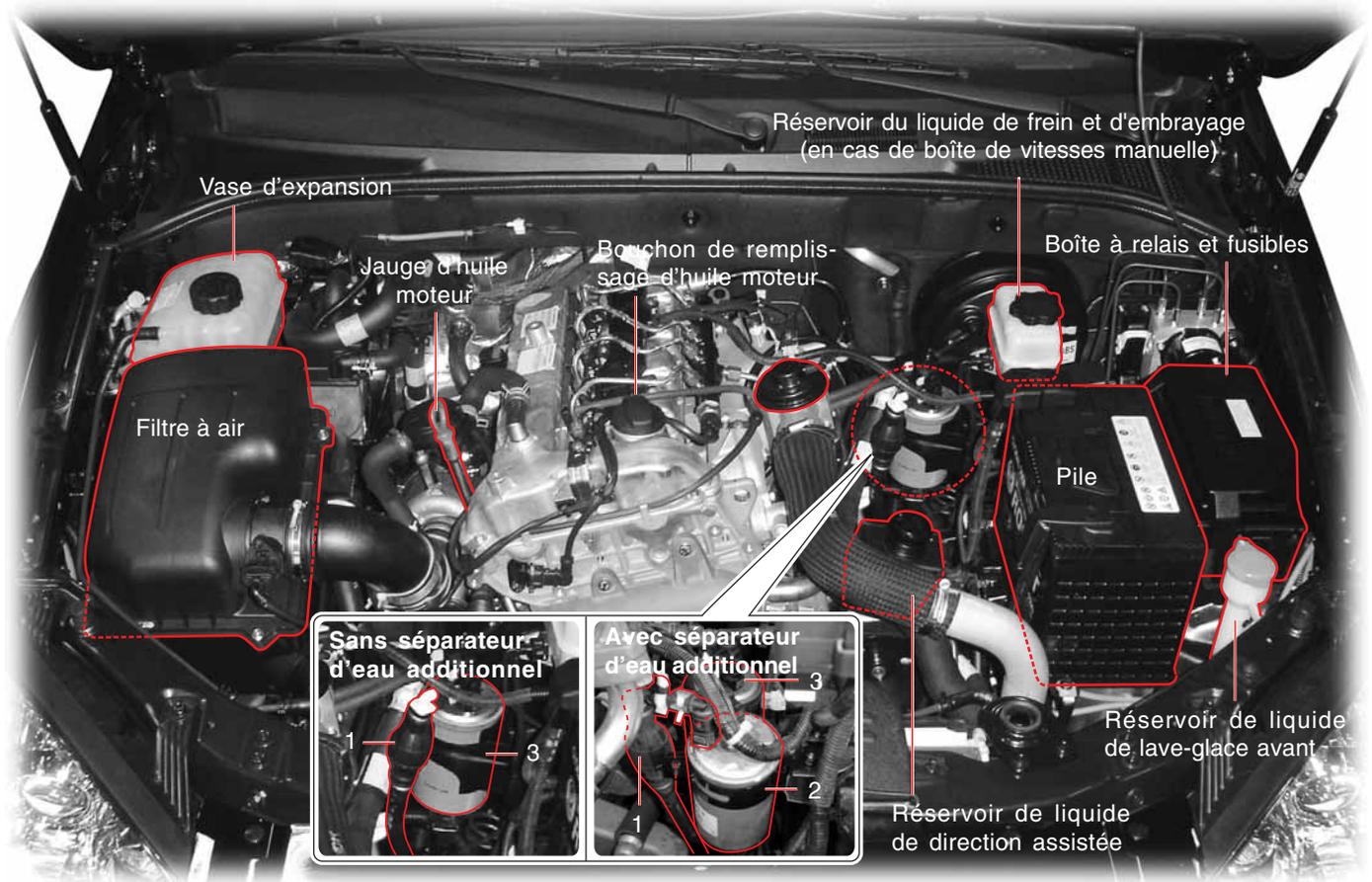
1. Pompe d'amorçage 2. Séparateur d'eau 3. Filtre à carburant
