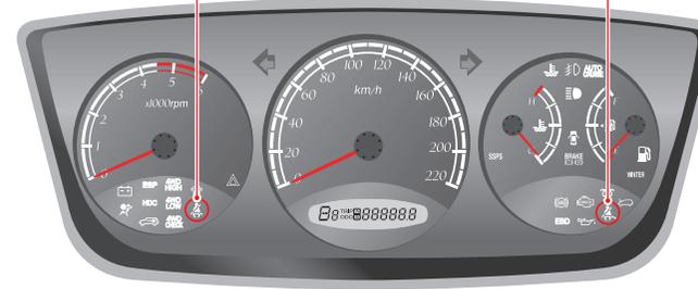
Quand le commutateur de contact est mis sur "ON" et que la ceinture de sécurité du conducteur n'est pas bouclée, le témoin de rappel s'allume et le vibreur retentit pendant 6 secondes. Ce rappel s'arrête quand le conducteur boucle sa ceinture même pendant la période de fonctionnement.
