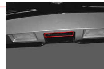
Pour ouvrir le hayon, déverrouillez le hayon et tirez le levier d'ouverture du hayon vers le haut.
