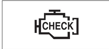
Le témoin de vérification du moteur sur le tableau de bord s'allume lorsque le carburant ou qu'un système électronique du moteur ne fonctionnent pas normalement. En conséquence, la puissance du moteur peut diminuer ou le moteur peut caler. Dans ce cas, contactez le distributeur Ssangyong le plus proche ou un atelier agréé.
