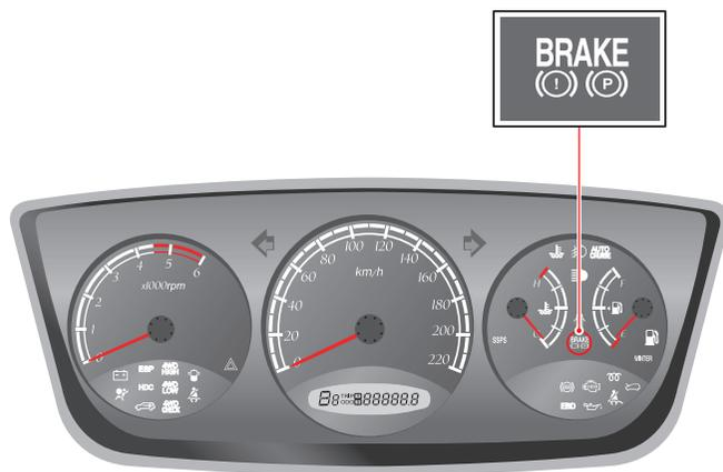
Ce témoin s'allume quand le frein de stationnement est serré et/ou quand le niveau du liquide de frein est insuffisant.
