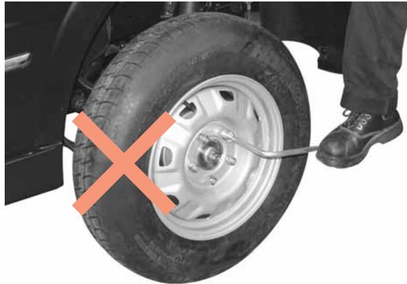
Un serrage excessif pourrait endommager les écrous de roue. Ne serrez pas excessivement les écrous de roue en pressant la clé d'écrou de roue au moyen des pieds ou d'un tuyau d'assistance.
