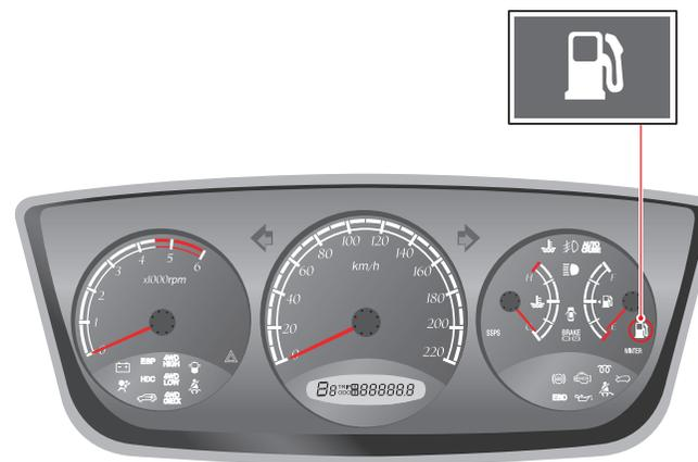
Ce témoin indique que le carburant va bientôt manquer. Le moment de l'éclairement du témoin varie en fonction des circonstances de fonctionnement du véhicule et de l'état de la route. N'attendez pas que le voyant soit allumé pour refaire le plein. Il est recommandé de rajouter du carburant dès que ce témoin s'allume.
