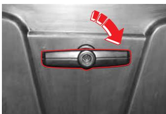
Déverrouillez le hayon et tournez le levier d'ouverture dans le sens des aiguilles d'une montre. Poussez ensuite le hayon vers l'extérieur.
