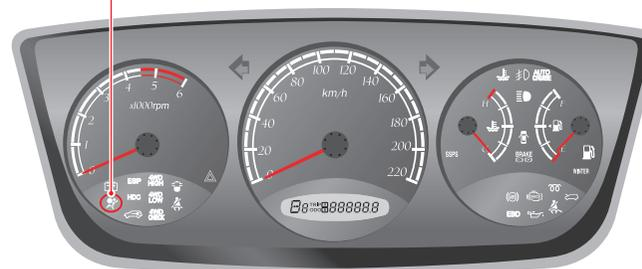
Quand le contact est allumé, ce témoin s'allume et doit s'éteindre ensuite, pour confirmer que l'airbag est opérationnel.
