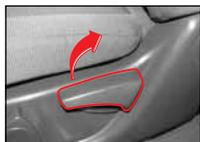
Pour modifier l'angle du dossier de siège, penchez-vous légèrement vers l'avant et levez le levier. Ensuite, penchez-vous vers l'arrière à l'angle du levier et relâchez le levier. Après le réglage, le levier doit retourner à son emplacement d'origine et le dossier de siège doit être verrouillé.
