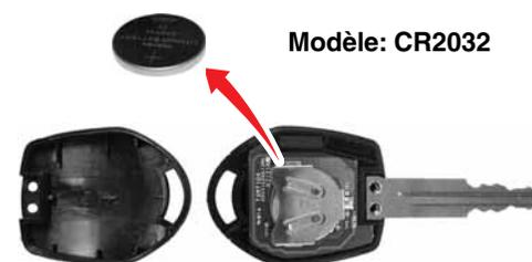
3. Retirez la pile et insérez une pile neuve.
