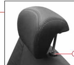
Pour lever l'appuie-tête, tirez vers le haut sans appuyer sur le bouton de déverrouillage. Pour abaisser l'appuie-tête, pressez le bouton de déverrouillage ① placé au sommet du dossier du siège et poussez l'appuie-tête vers le bas.
