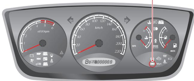
Ce témoin s'allume quand le commutateur d'allumage est sur "ON" et doit s'éteindre si le système est normal. Si le système EBD est anormal, le témoin EBD reste allumé.
