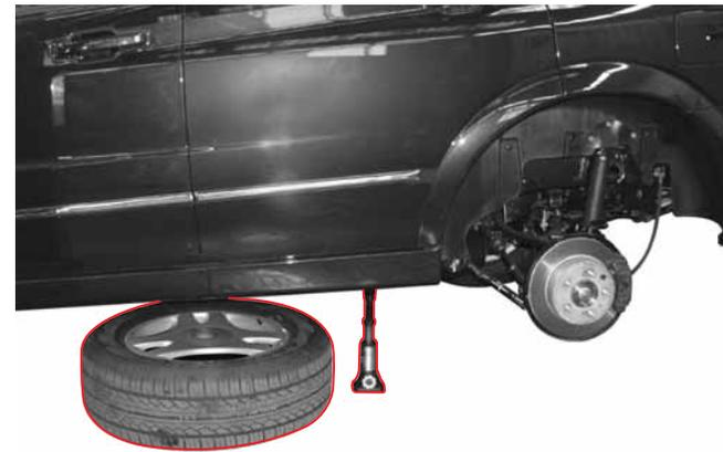
4. Combinez le cric, la clé d'écrou de roue et le raccord de cric comme illustré. Levez le véhicule en faisant tourner la clé combinée dans le sens des aiguilles d'une montre pour dégager le pneu du sol, de 3 cm environ.
