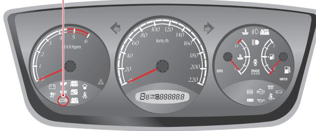
Ce témoin s'allume quand la clé de contact est en communication avec l'unité de commande du moteur (ECU) (pendant le démarrage du moteur) pendant 0,5 seconde.
