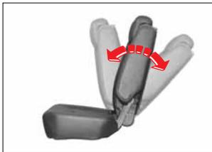
Pour modifier l'angle du dossier de siège, penchez-vous légèrement vers l'avant et levez le levier (A). Ensuite, penchez-vous vers l'arrière à l'angle du levier et relâchez le levier. Après le réglage, le levier doit retourner à son emplacement d'origine et le dossier de siège doit être verrouillé.
