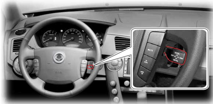
La régulation de vitesse est un système de commande automatique de la vitesse du véhicule qui maintient une vitesse désirée sans utiliser la pédale d'accélérateur.
