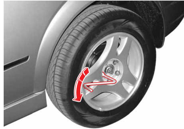
2. Desserrez les écrous de roue d'un ou deux tours en tournant au moyen de la clé dans le sens inverse des aiguilles d'une montre.
